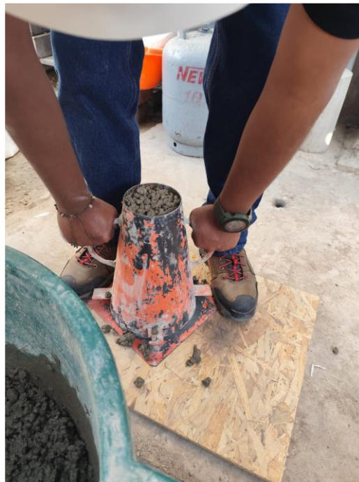
MEDICION DEL ASENTAMIENTO "SLUMP"
