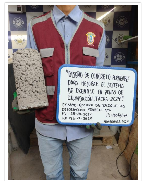
FOTO N° Ensayo de roturas de probetas de muestras cilíndricas "PROBETA N°06" antes de la rotura. 011 NORMA : ASTM-C39 / MTC E 704 / NTP 339.034
