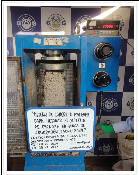
FOTO N° 006 Ensayo de roturas de probetas de muestras cilíndricas "PROBETA N°03" después de la rotura. NORMA : ASTM-C39 / MTC E 704 / NTP 339.034
