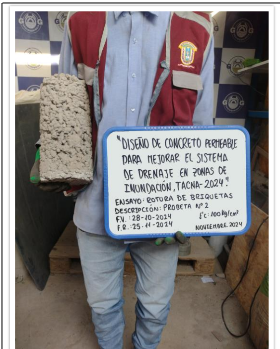
FOTO N° 003 Ensayo de roturas de probetas de muestras cilíndricas "PROBETA N°02" antes de la rotura. NORMA : ASTM-C39 / MTC E 704 / NTP 339.034
