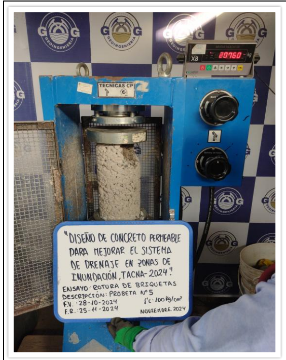
FOTO N° Ensayo de roturas de probetas de muestras cilíndricas "PROBETA N°05" después de la rotura. 010 NORMA : ASTM-C39 / MTC E 704 / NTP 339.034
