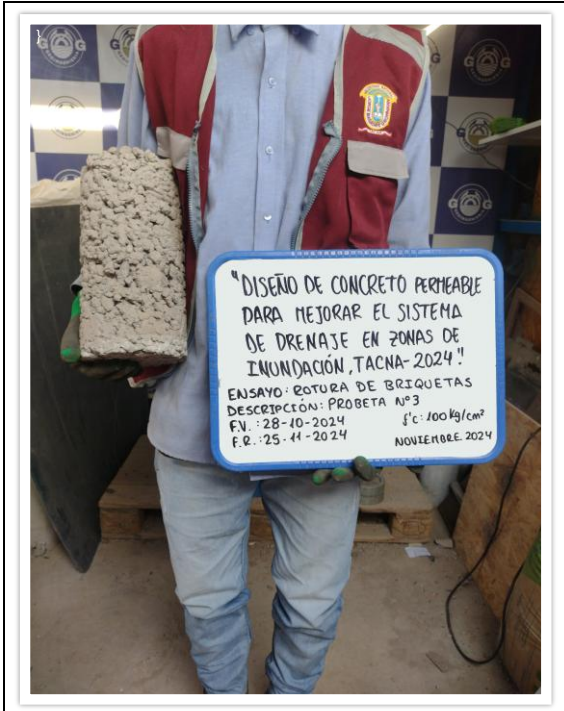
FOTO N° 005 Ensayo de roturas de probetas de muestras cilíndricas "PROBETA N°03" antes de la rotura. NORMA : ASTM-C39 / MTC E 704 / NTP 339.034
