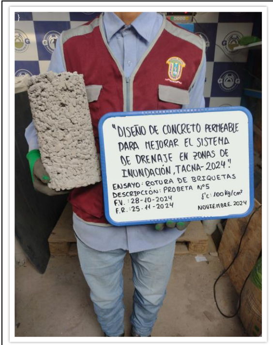
FOTO N° Ensayo de roturas de probetas de muestras cilíndricas "PROBETA N°05" antes de la rotura. 009 NORMA : ASTM-C39 / MTC E 704 / NTP 339.034
