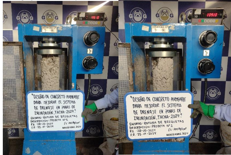
Fotografía 3-2: Ensayo de resistencia a la compresión del concreto.
