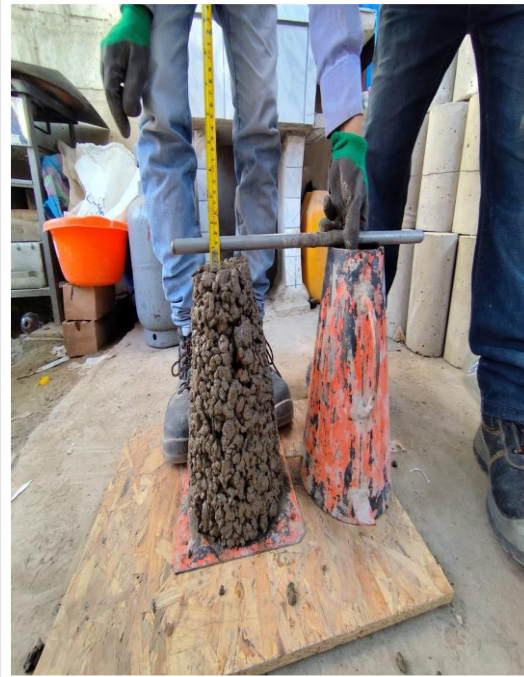
MEDICION DEL ASENTAMIENTO "SLUMP"
