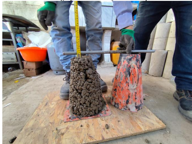
Fotografía 3-1: Ensayo de Slump.
