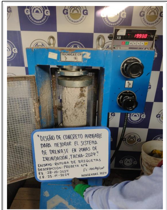
FOTO N° Ensayo de roturas de probetas de muestras cilíndricas "PROBETA N°06" después de la rotura. 012 NORMA : ASTM-C39 / MTC E 704 / NTP 339.034
