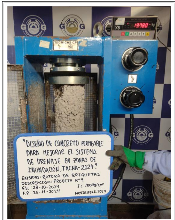
FOTO N° 008 Ensayo de roturas de probetas de muestras cilíndricas "PROBETA N°04" después de la rotura. NORMA : ASTM-C39 / MTC E 704 / NTP 339.034
