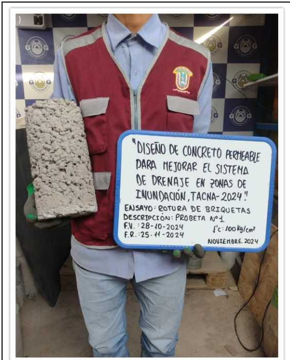
FOTO N° 001 Ensayo de roturas de probetas de muestras cilíndricas "PROBETA N°01" antes de la rotura. NORMA : ASTM-C39 / MTC E 704 / NTP 339.034
