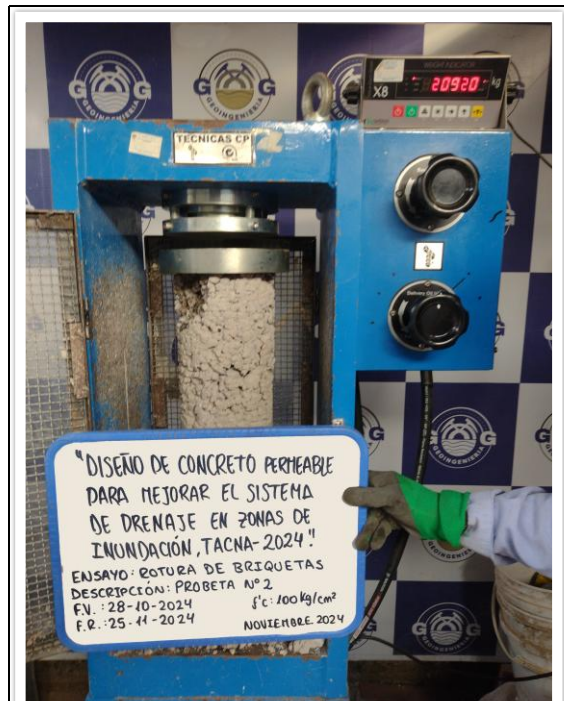
FOTO N° 004 Ensayo de roturas de probetas de muestras cilíndricas "PROBETA N°02" después de la rotura. NORMA : ASTM-C39 / MTC E 704 / NTP 339.034
