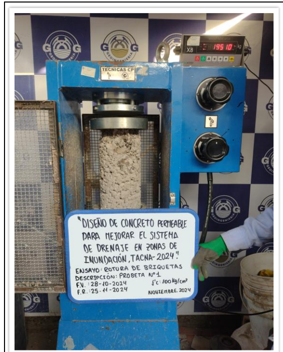
FOTO N° 002 Ensayo de roturas de probetas de muestras cilíndricas "PROBETA N°01" después de la rotura. NORMA : ASTM-C39 / MTC E 704 / NTP 339.034
