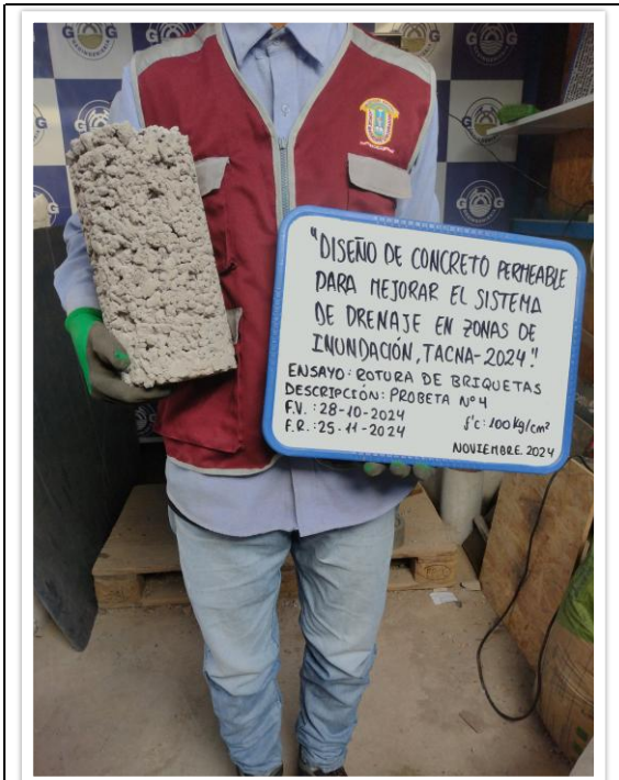
FOTO N° 007 Ensayo de roturas de probetas de muestras cilíndricas "PROBETA N°04" antes de la rotura. NORMA : ASTM-C39 / MTC E 704 / NTP 339.034
