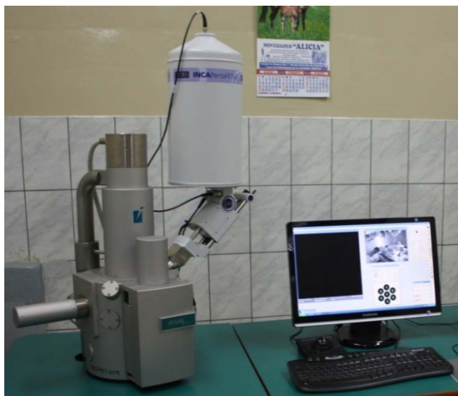
Figura 2: Microscopio Electrónico de Barrido del laboratorio de la escuela de metalurgia.
