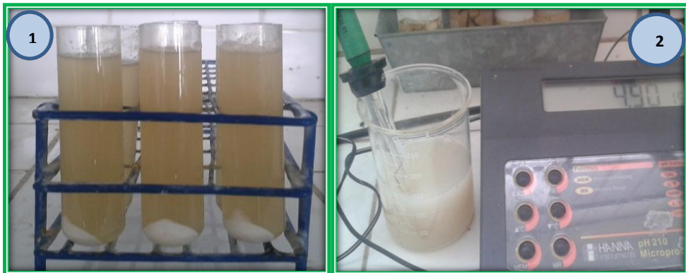
Fotografía 5. Tubos de ensayo con proteínas solubilizadas (1), cambio de pH a la solución después del primer centrifugado (2).
