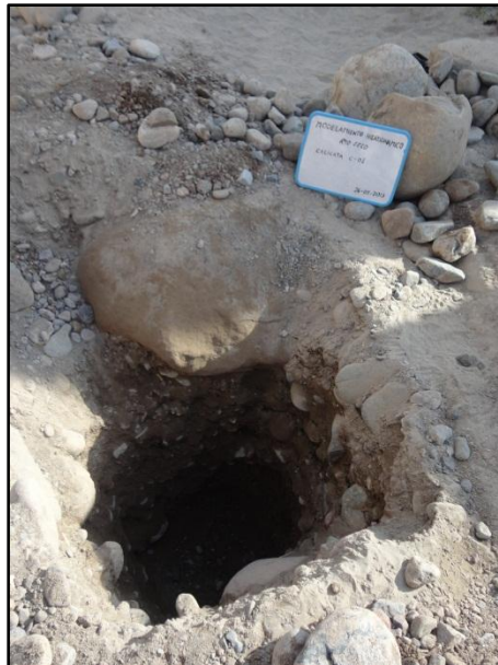
Foto N°10. Vista de la calicata C-1 conformada por gravas arenosas mal graduadas color pardo grisáceo en el fondo.
