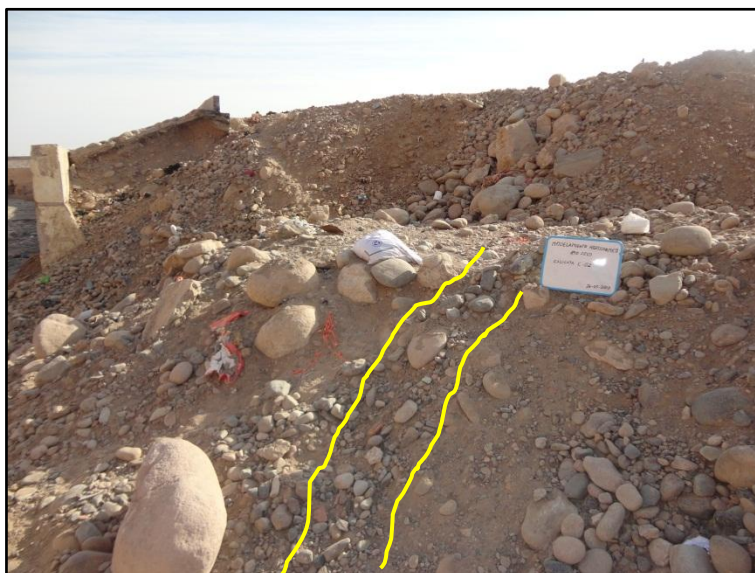
Foto N°11. Vista donde las líneas amarillas indican la excavación y recolección de muestra T-1 de la margen derecha
