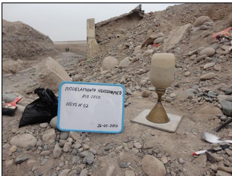
Foto N°09 Vista donde se observa el ensayo de densidad natural de campo en la margen derecha, profundidad del hoyo 0,16m.
