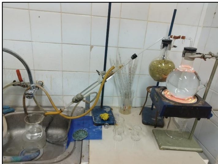
Equipo de extracción del aceite esencial de Minthostachys mollis , “muña”, por el Método de arrastre del vapor.
