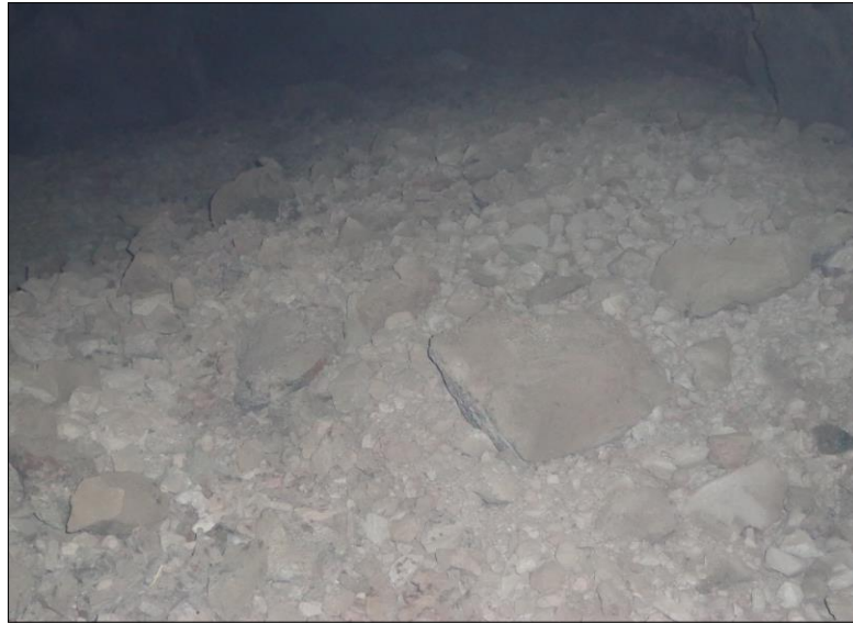
Figura 49. Imagen de la granulometría después de la voladura. Fuente: Elaboración propia.
