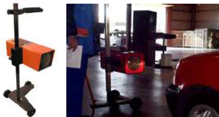
Figura 1. Regloscopio y prueba de Alineación de Luces
