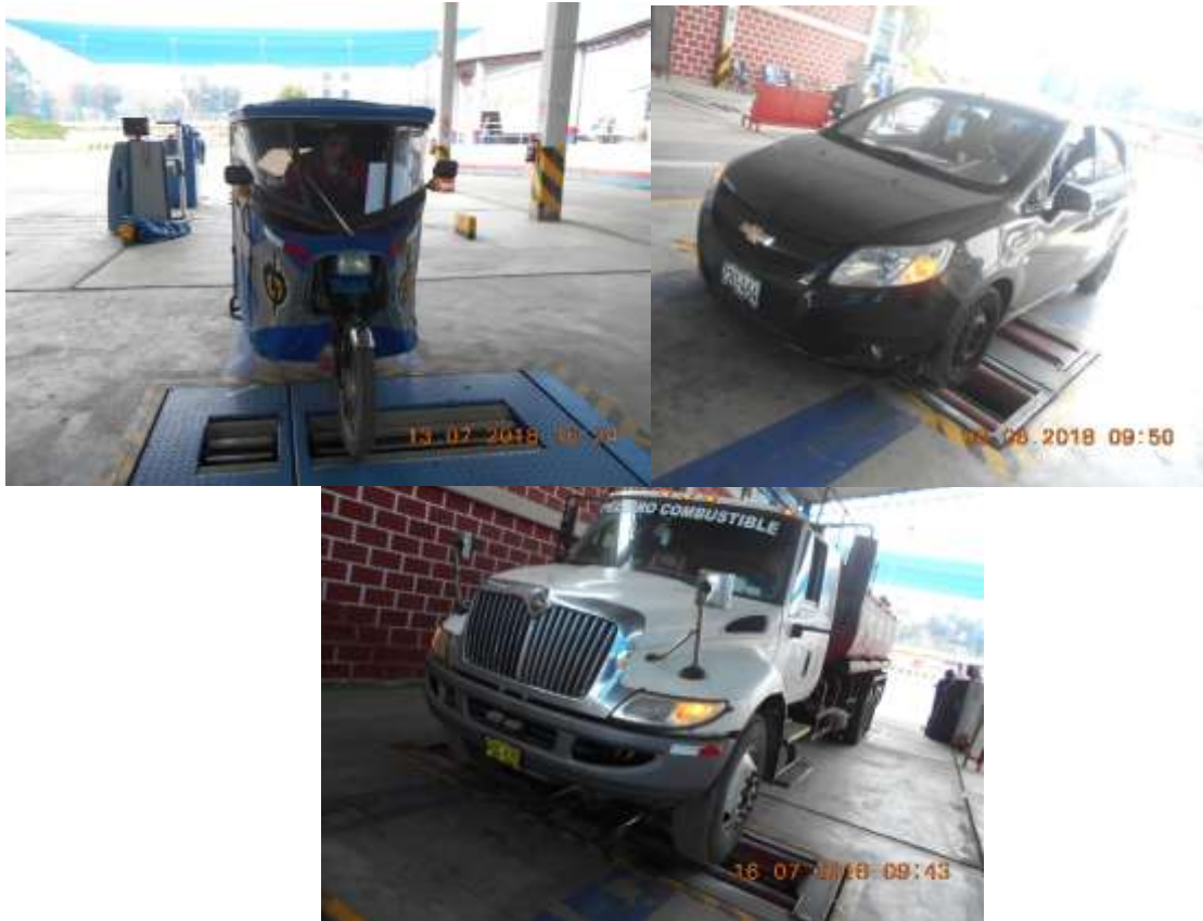
Figura 33. Procedimiento de medición del frenómetro Fuente: Elaboración propia
