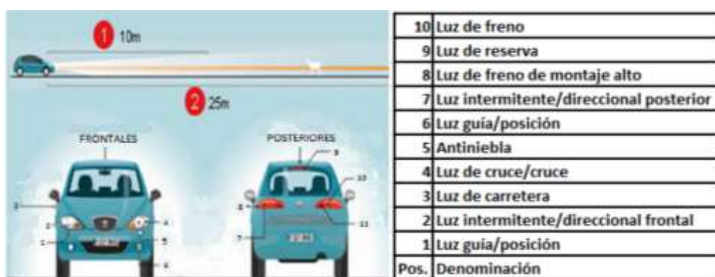
Figura 17. Sistema de señalización y advertencia de un vehículo.
