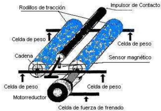
Figura 5. Esquema del frenómetro Fuente: (Ramos, 2009)
