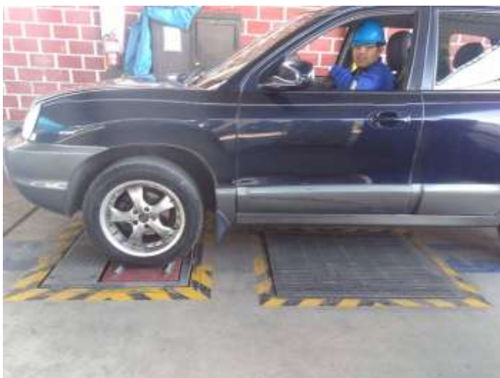
Figura 27. Procedimiento de medición del banco de suspensión. Fuente: Elaboración propia
