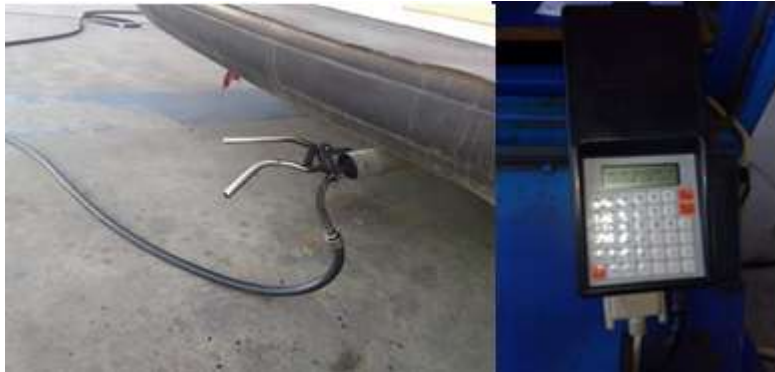
Figura 24. Procedimiento de medición con el opacímetro Fuente : Elaboracion propia
