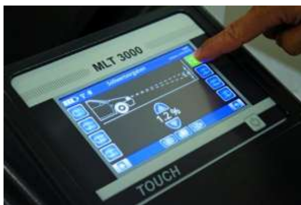
Figura 20. Pantalla de operación del luxómetro
