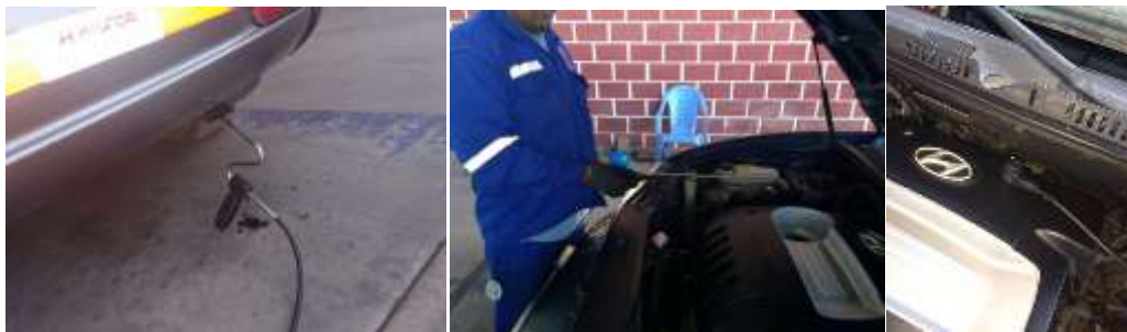
Figura 22. Procedimiento de medición del analizador de gases Fuente: Elaboración propia
