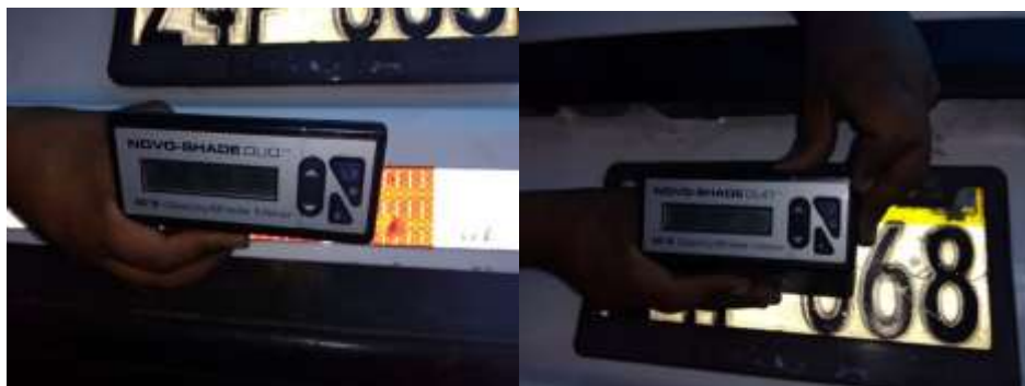
Figura 40. Procedimiento de medición del reflectómetro Fuente: Elaboracion propia.
