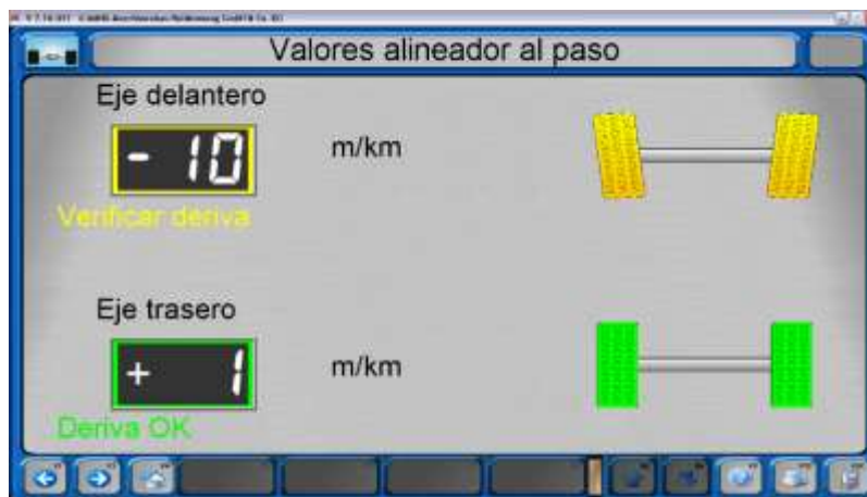
Figura 31. Resultados de la prueba alineador al paso Fuente: Elaboración propia
