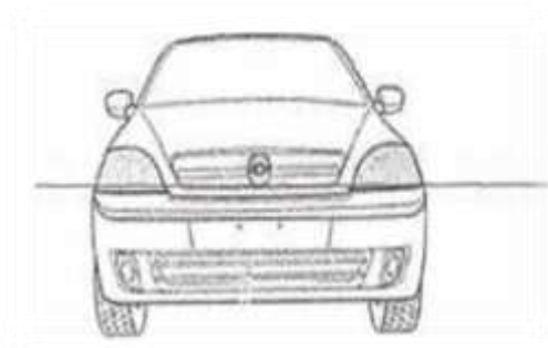
Figura 19. Posición correcta del vehículo previo a la inspección
