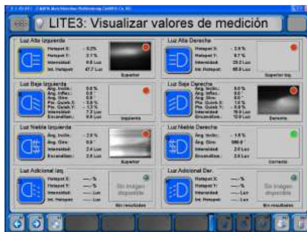
Figura 21. Resultados de la medición del luxómetro y regloscopio Fuente: Elaboración propia
