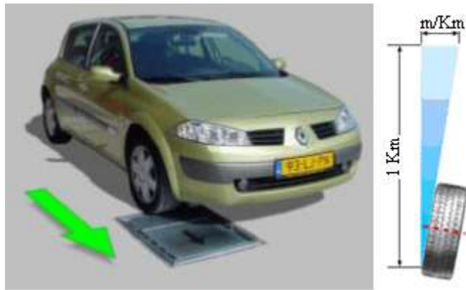
Figura 29. Vehículo sobre Alineador al Paso Fuente: (Ramos, 2009)
