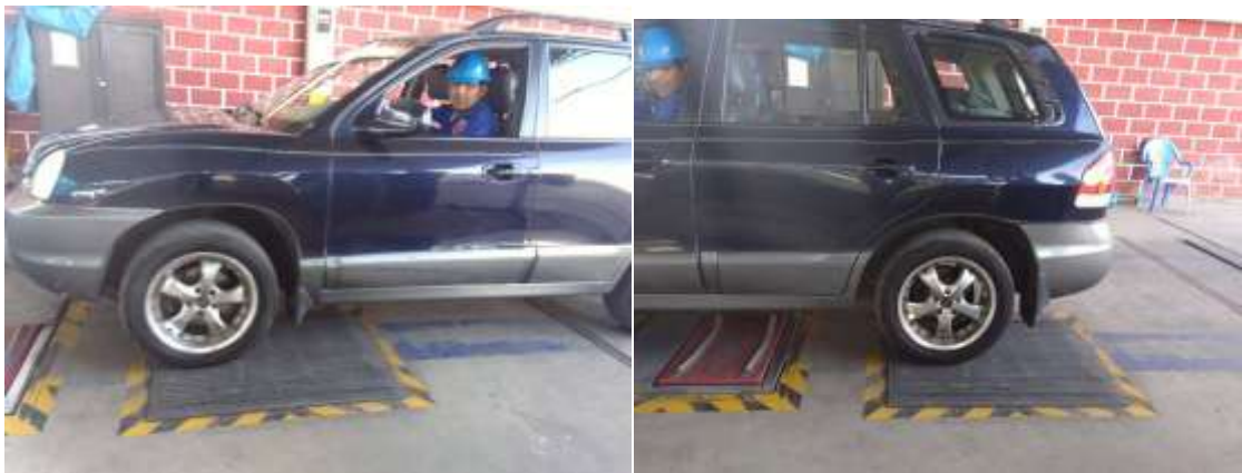
Figura 30. Procedimiento de medición en el medidor de alineación de ruedas al paso Fuente: Elaboración propia
