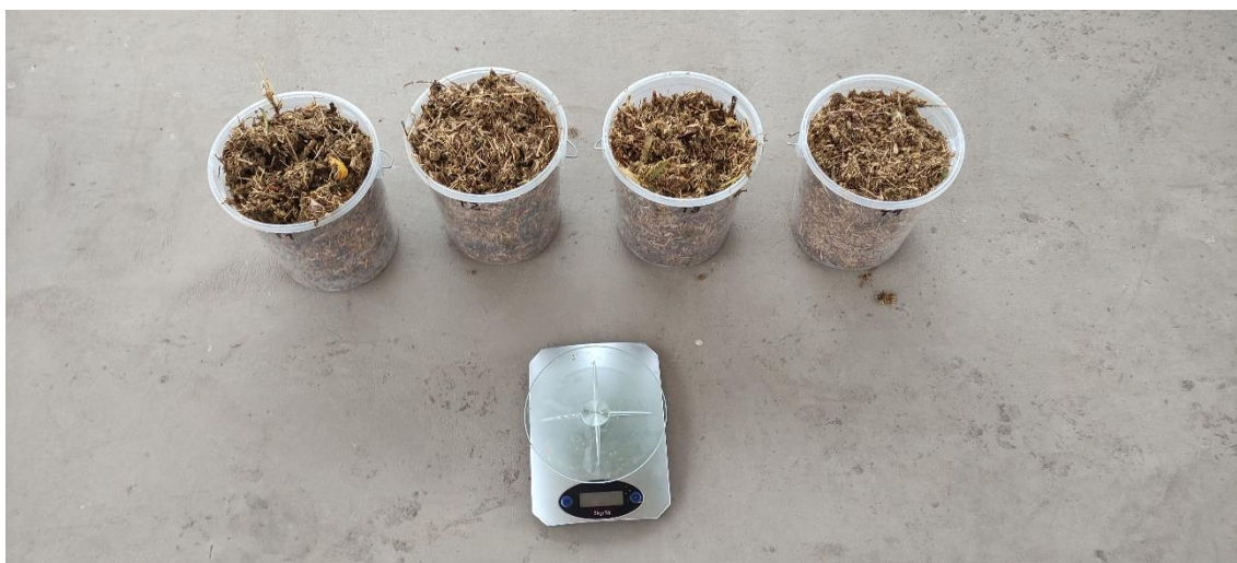
Balde + Residuo orgánico triturado para la determinación de densidad aparente (DA), Espacios Libres de Aire (FAS) en muestras de compost inicial.
