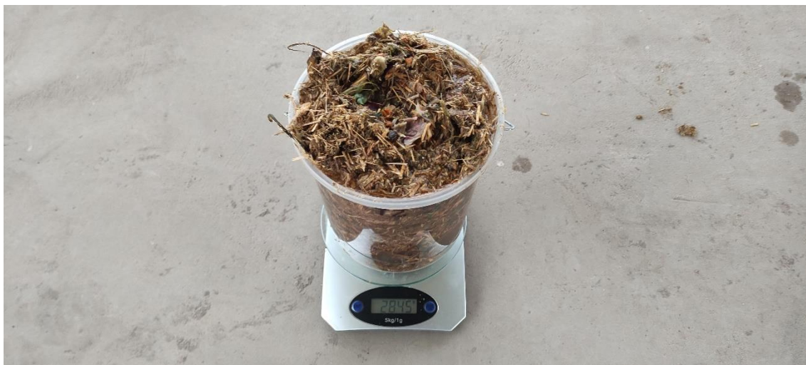
Determinación del peso del Balde + Residuo orgánico triturado para la determinación de densidad aparente (DA), Espacios Libres de Aire (FAS) en muestras de compost inicial.
