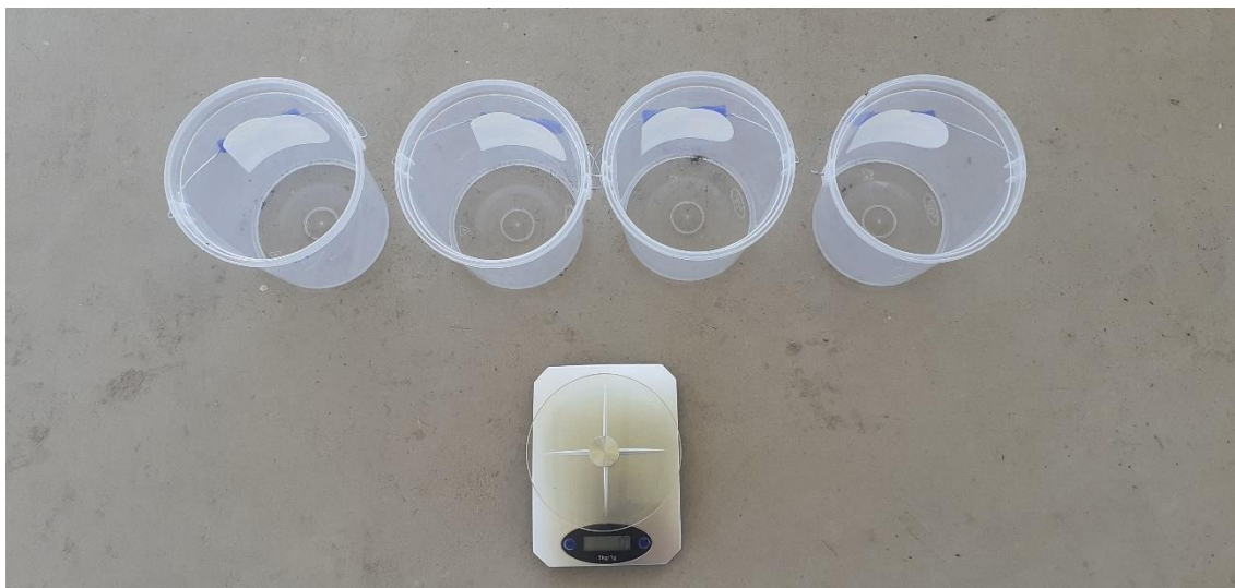
Pesaje de balde para la determinación de densidad aparente (DA), Espacios Libres de Aire (FAS) en muestras de compost.
