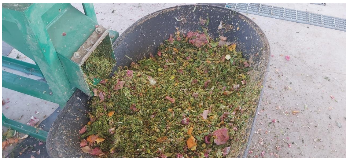
Salida de residuos sólidos orgánicos triturados
