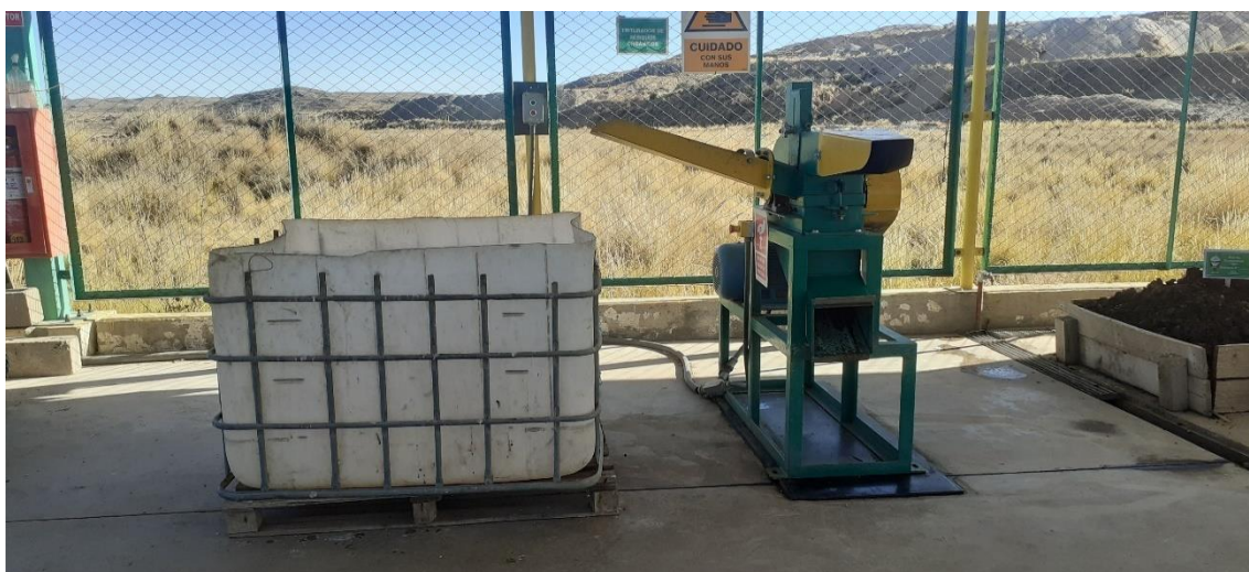
Máquina trituradora de residuos sólidos orgánicos crudos.
