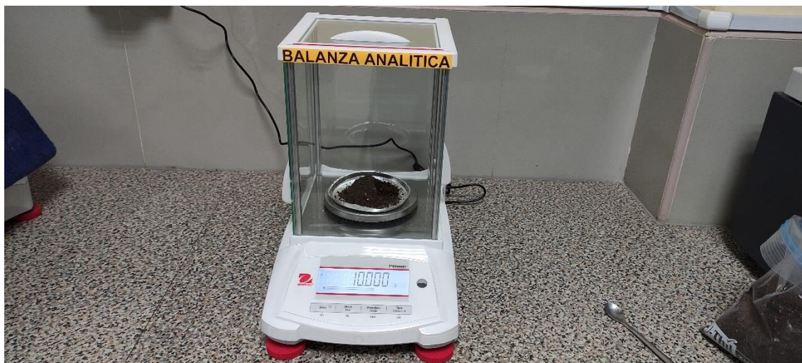
Pesado de muestras de compost para determinación de toxicidad de compost.
