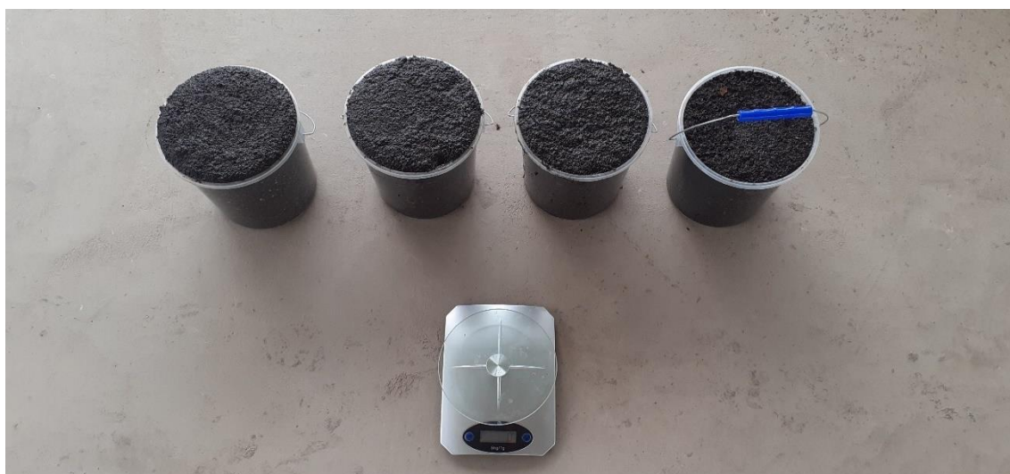
Determinación del peso del balde con compost y agua para la determinación de densidad aparente (DA), Espacios Libres de Aire (FAS) en muestras de compost.
