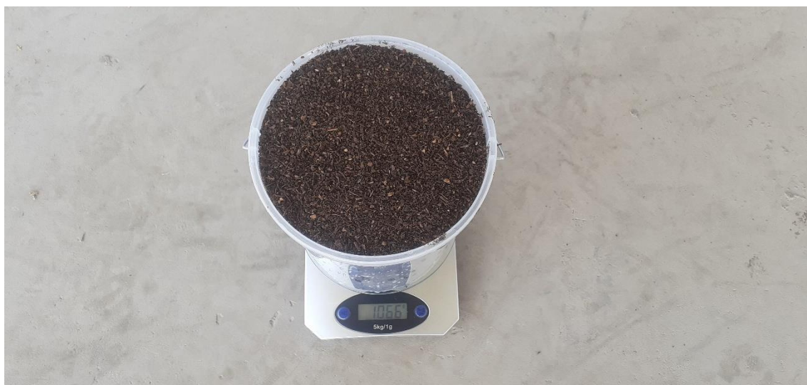
Determinación del peso de balde + Compost para la determinación de densidad aparente (DA), Espacios Libres de Aire (FAS) en muestras de compost.
