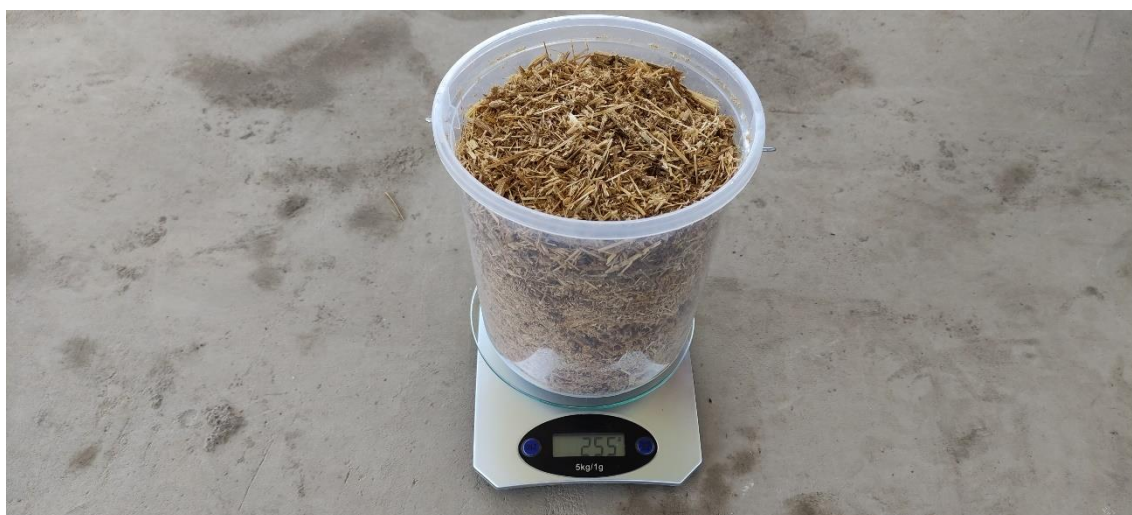
Determinación de densidad aparente (DA), Espacios Libres de Aire (FAS) y Capacidad de absorción de agua (WAC) de Schoenoplectus tatora.
