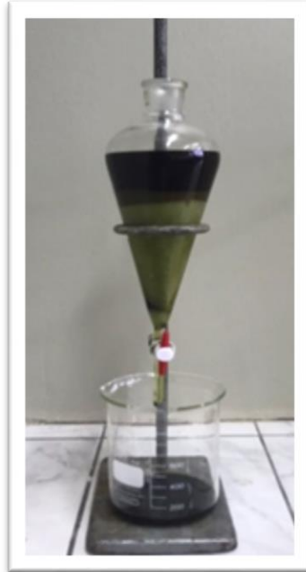
Figura 19. Se armó el equipo de percolación, se dejó en maceración por 24 horas y luego se filtró.
