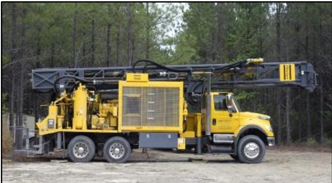
Figura 26. Perforadora de pozos de agua T3W
