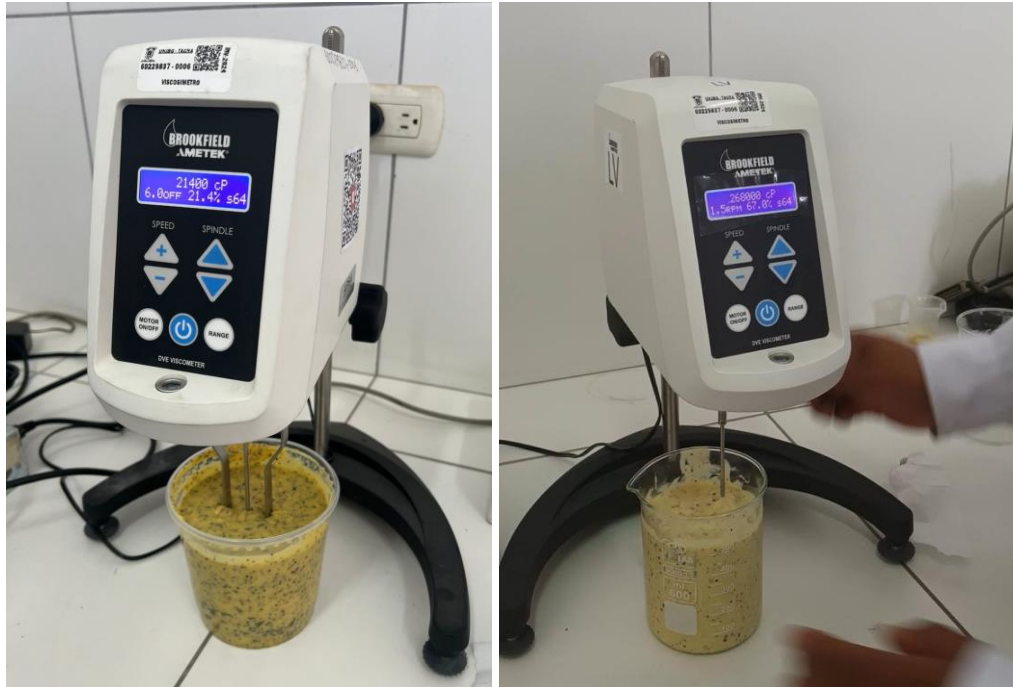
Figura 5. Medición de las características reológicas del helado (mezcla base a 19 °C y helado a 11 °C)
