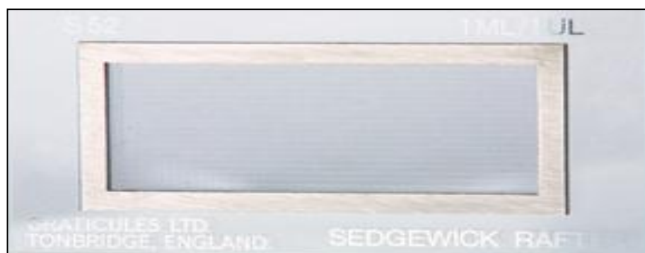
Figura 3: Cámara Sedgwick Rafter de 1 ml (células/ml)
