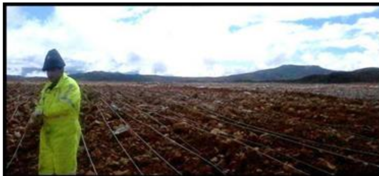
Figura 6: Vista de una celda ya terminada, lista para el regado por goteo Fuente: Geología minera La Zanja
