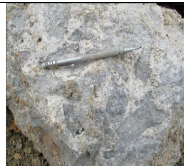
Figura 8. Brecha monomítica matriz soportante con clastos silicificados Fuente: Geología minera La Zanja 2 014
