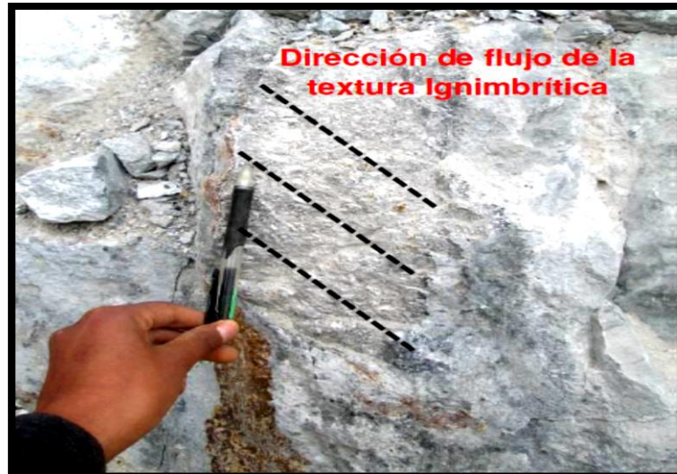
Figura 6. Tufo cristalolítico, textura ignimbrítica mostrando dirección de flujo, alteración argílica avanzada, con 2 % de pirita.
