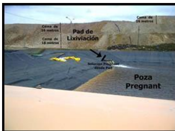
Figura 7: Descarga de solución del Pad a Poza Pregnat Fuente: Geología minera La Zanja
