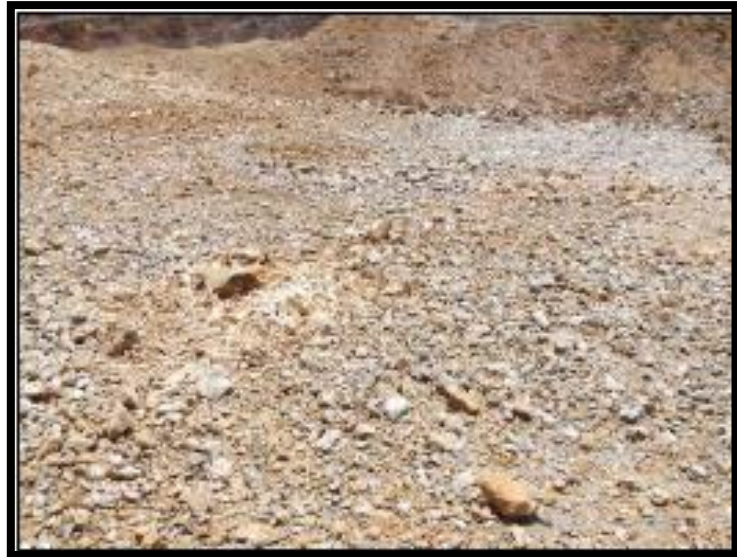
Figura 21. Muestra una imagen donde se utilizó SAN-G con una densidad de 1,05 g/cm 3 en una arenisca. Fuente: Geología minera La Zanja 2 014
