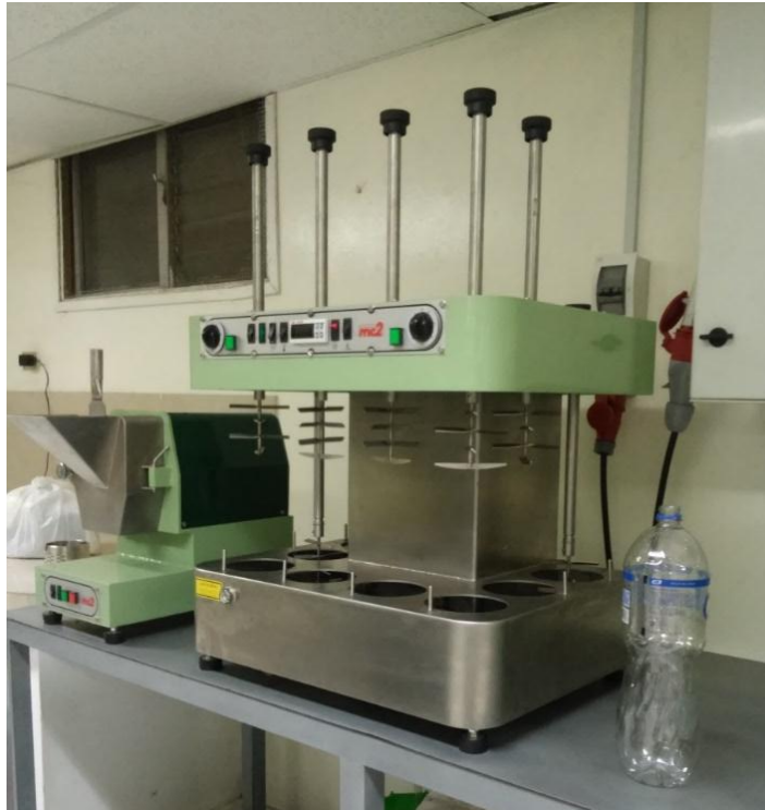
Figura 10. Sistema de extracción de aceite de oliva Abencor Fuente: Elaboración propia (2016)
