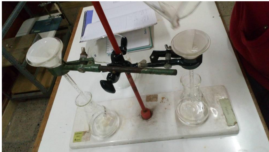
Foto 6: Filtrado del agua tratada Fuente: Propia
