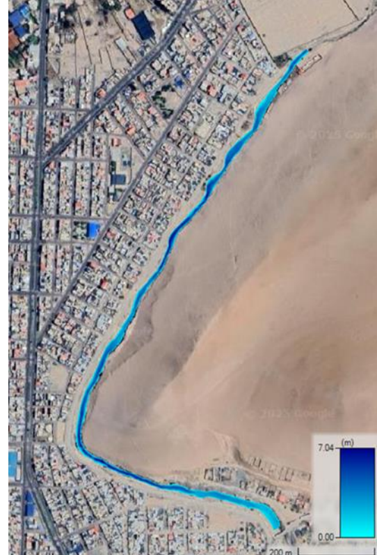
Simulación Hidráulica en HEC-RAS (TR=200)
