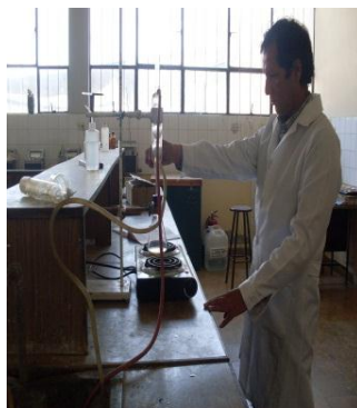
Figura 20. Extracción de aceite palta con equipo Soxhlet.
