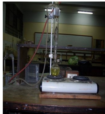
Figura 20. Extracción de aceite palta con equipo Soxhlet.
