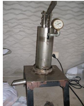
Figura 18. Prensado de pasta de palta en mazo y mortero y prensa mecánica.
