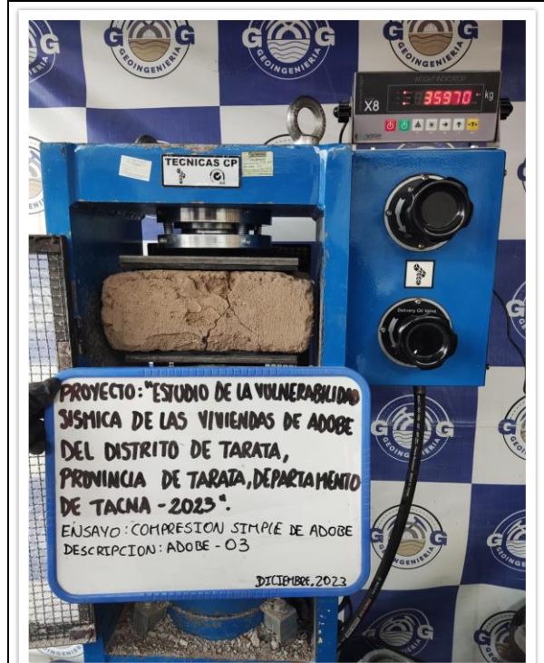
FOTO N° 006 Ensayo de roturas de probetas de muestras cilindricas "ADOBE 03" despues de la rotura. NORMA : ASTM-C39 / MTC E 704 / NTP 339.034
