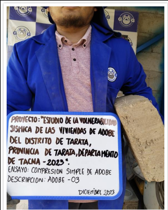
FOTO N° 005 Ensayo de roturas de probetas de muestras cilindricas "ADOBE 03" antes de la rotura NORMA : ASTM-C39 / MTC E 704 / NTP 339.034
