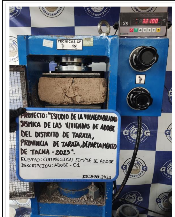
FOTO N° 002 Ensayo de roturas de probetas de muestras cilindricas "ADOBE 01" despues de la rotura. NORMA : ASTM-C39 / MTC E 704 / NTP 339.034
