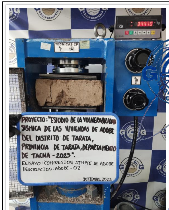
FOTO N° 004 Ensayo de roturas de probetas de muestras cilindricas "ADOBE 02" despues de la rotura. NORMA : ASTM-C39 / MTC E 704 / NTP 339.034
