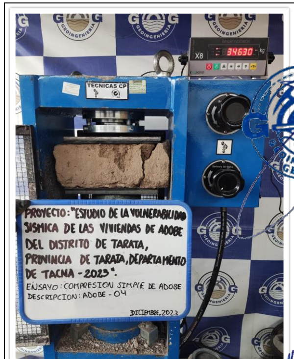
FOTO N° 008 Ensayo de roturas de probetas de muestras cilindricas "ADOBE 04" despues de la rotura. NORMA : ASTM-C39 / MTC E 704 / NTP 339.034
