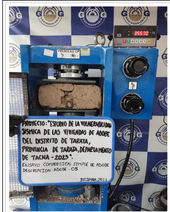
FOTO N° 010 Ensayo de roturas de probetas de muestras cilindricas "ADOBE 05" despues de la rotura. NORMA : ASTM-C39 / MTC E 704 / NTP 339.034
