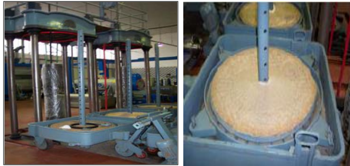
Vista de Prensas y Carro con Capacho
