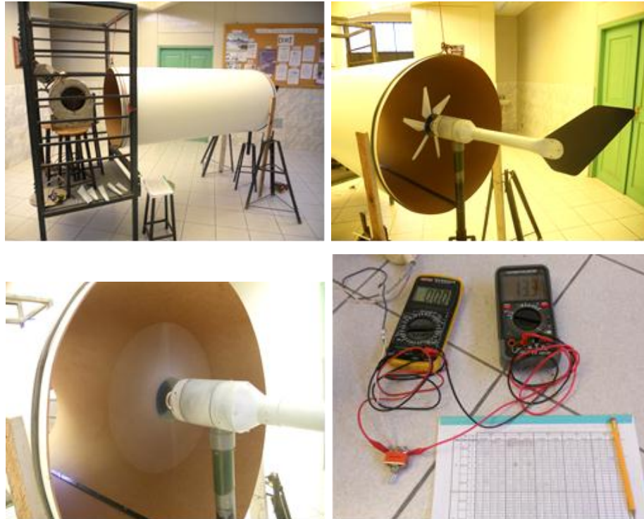
Figura 22. Evaluación en laboratorio usando un túnel cilíndrico. Fuente Elaboración Propia.
