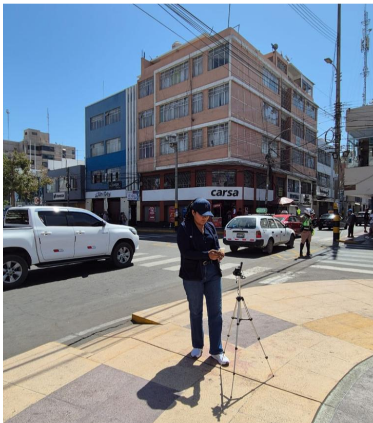
Foto 19: En la imagen se aprecia la toma de muestras con estación fija de monitoreo de la temperatura, viento y humedad.
