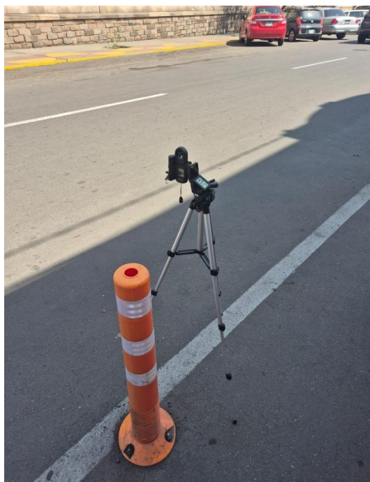
Foto 18: En la imagen se aprecia la toma de datos, tanto Temperatura y Humedad con el Higrómetro. De igual manera, el Viento con el Anemómetro. Ambas mediciones fueron tomadas en simultaneo. .
