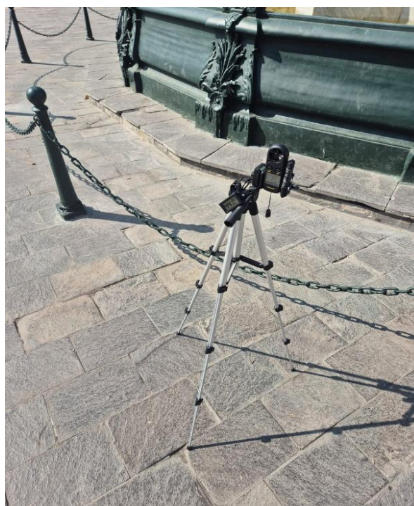
Foto 16: En la imagen se aprecia la toma de datos, tanto Temperatura y Humedad con el Higrómetro. De igual manera, el Viento con el Anemómetro. Ambas mediciones fueron tomadas en simultáneo. La medida Fue tomada en la zona de la Pileta Ornamental de Tacna. Así mismo, se aprecia la materialidad la cual es Piedra Pizarra Negra.
