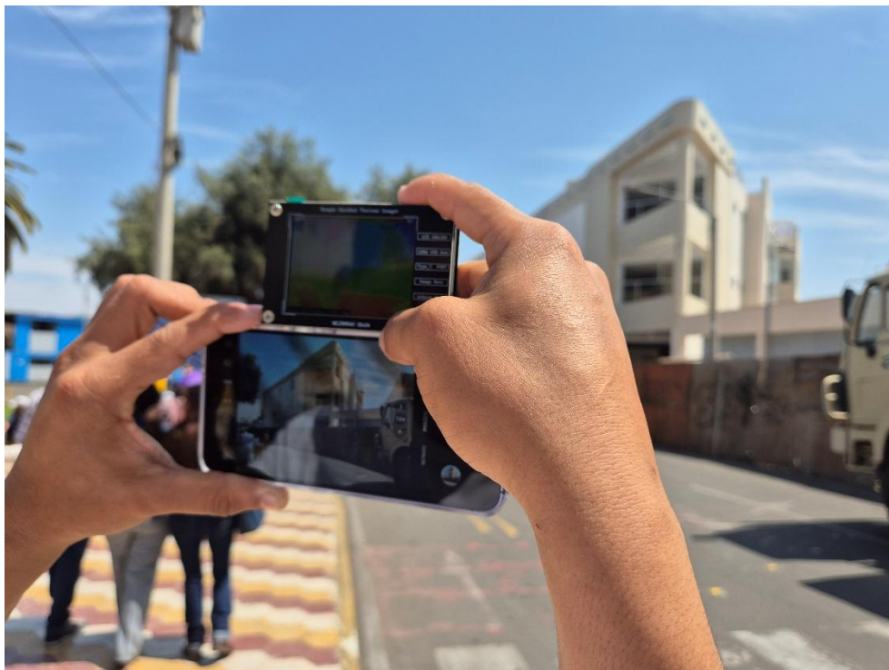
Foto 22: En la imagen se aprecia la toma fotografías térmicas e imágenes fotográficas para posteriormente hacer la superposición de imágenes.
