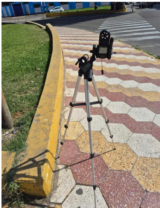
Foto 17: En la imagen se aprecia la toma de datos, tanto Temperatura y Humedad con el Higrómetro. De igual manera, el Viento con el Anemómetro. Ambas mediciones fueron tomadas en simultaneo. La medida Fue tomada en El lado lateral de la Plaza Juan Pablo II, frente al Centro De Convenciones Jorge Basadre Ex Miculla.
