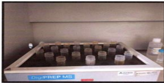
Figura N°01. Digestión ácida en el equipo DigiPREP MS.- Proceso de digestión ácida de las muestras de ají amarillo mediante el equipo DigiPREP MS, utilizado para la mineralización de la matriz vegetal y la liberación del arsénico presente en la muestra.
