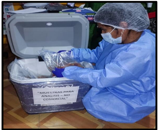
IMAGEN 24. Colocación de las muestras de ají amarillo seco en el contenedor isotérmico rotulado para garantizar su conservación durante el traslado al laboratorio.
