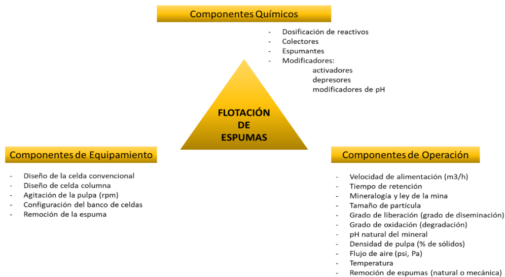
Componentes de un sistema de flotación de espumas
