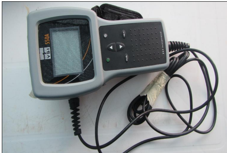
Figura 14. Oxímetro digital YSI 550a, mide concentración de oxígeno disuelto en el agua (mg/l) y temperatura (°C).
