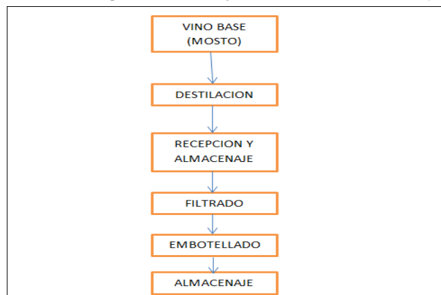
Gráfico 2: Diagrama de flujo de elaboración de pisco
