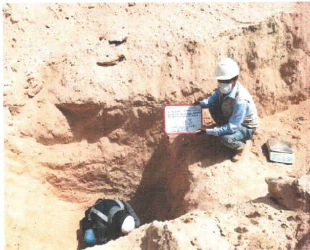
Fotografía 15 Ensayo de densidad In situ en la calicata C-03
