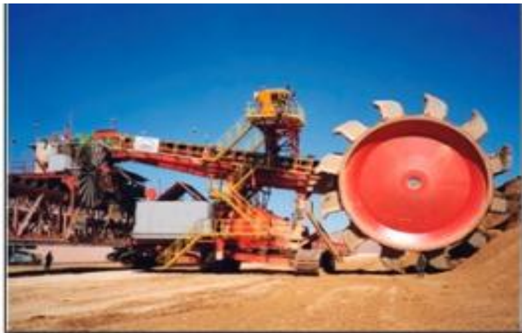
Figura 4. Rotopala para descarga de ripios Fuente: Direct Industry, 2014
