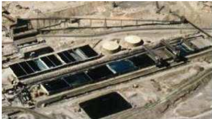
Figura 10. Lixiviación en Bateas Fuente: R, Soto, octubre 2012
