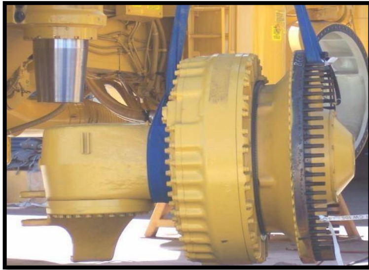
Figura 25: Instalación de bocamaza posición LH
