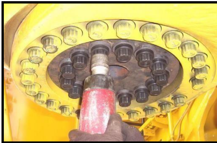
Figura 26: Secuencia de torque de pernos de bocamaza.
