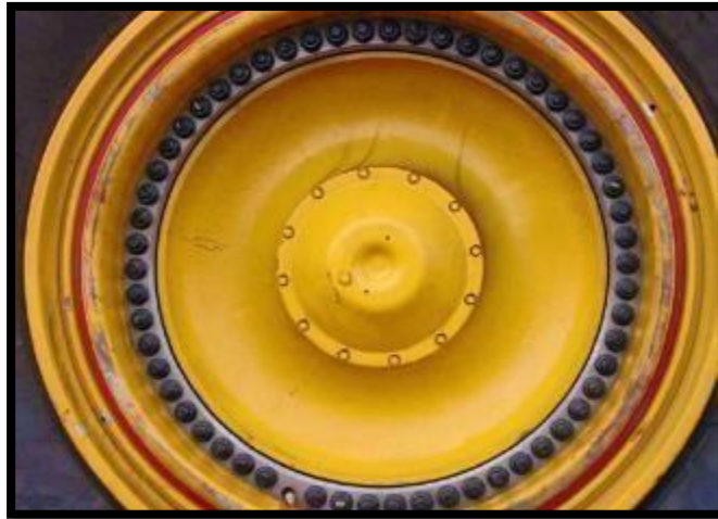
Figura 45: Neumático instalado y torqueado
