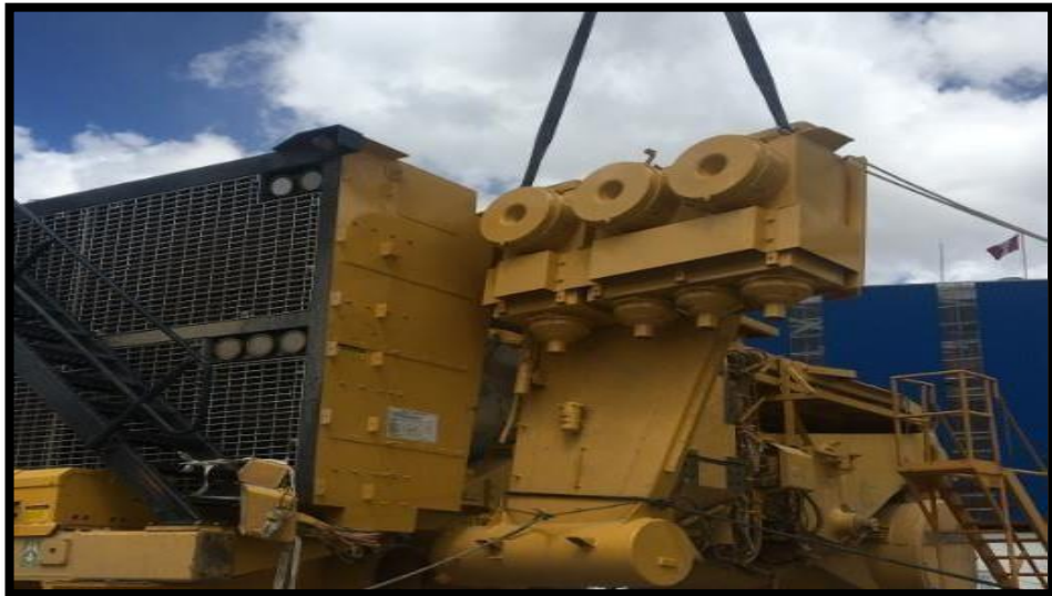
Figura 12: Instalación de alerones posición LH
