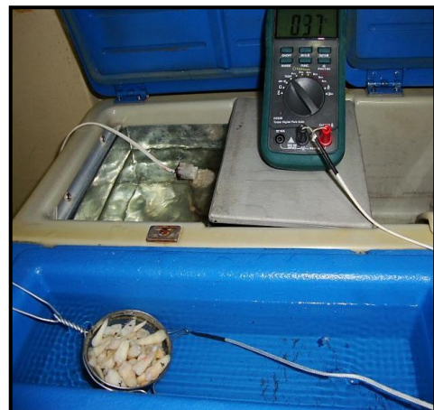
Fig. 29 Piezas dentales sumergidas en agua a 37°C con una diferencia de temperaturas de +/- 3°C por 30 segundos.
