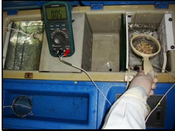
Fig. 30 Piezas dentales sumergidas en agua a 5°C con una diferencia de temperaturas de +/- 3°C por 30 segundos.
