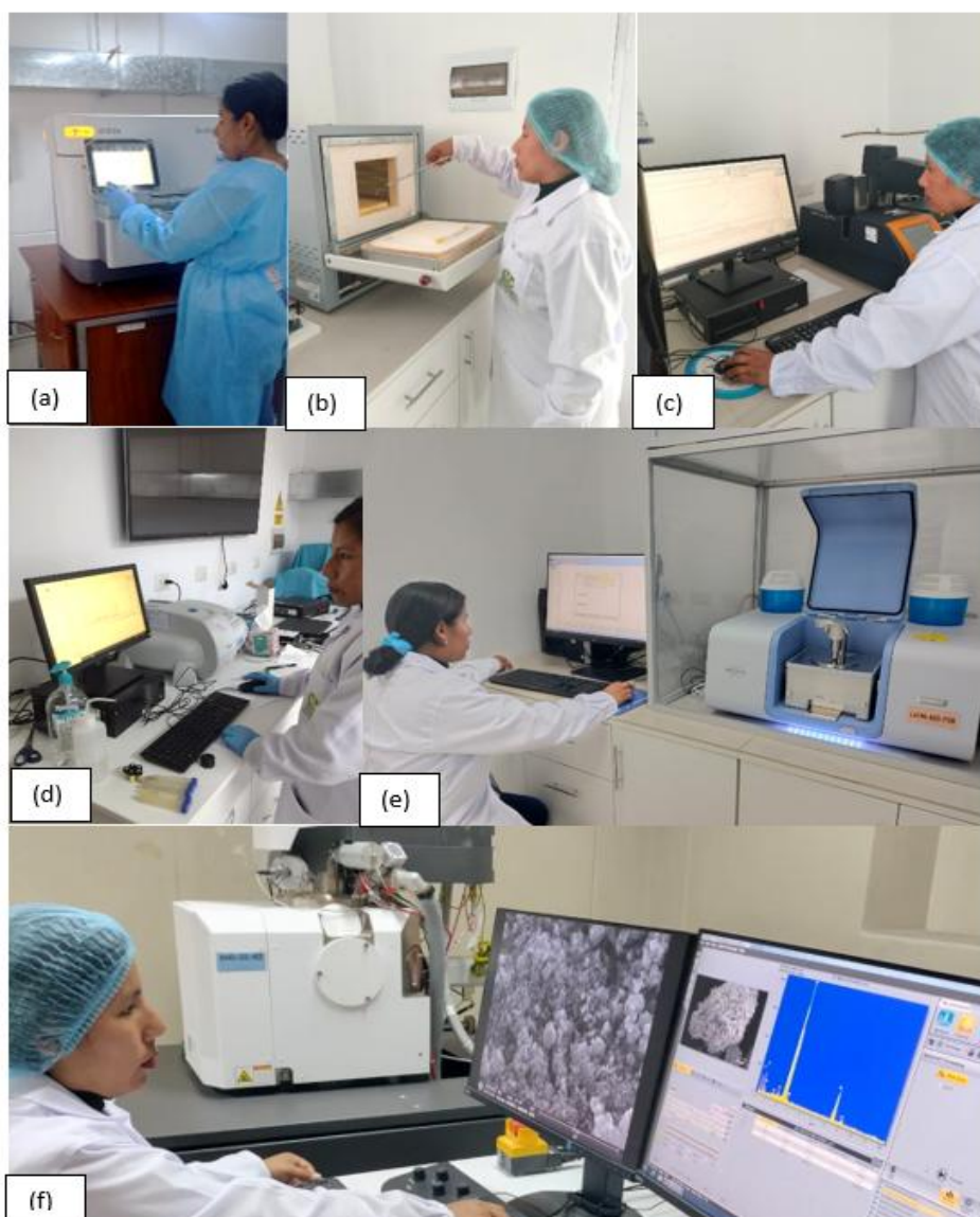
(a) Caracterización por difracción de rayos X (XRD), (b) Cristalización de NPs de ZnO por calcinación, (c) Caracterización termogravimétrica (TGA) y calorimetría diferencial de barrido (DSC) (d) Caracterización por espectroscopía UV-visible (e) Caracterización por espectroscopía infrarroja por transformada de Fourier (FTIR) y (f) Caracterización por microscopía electrónica de barrido (SEM)
