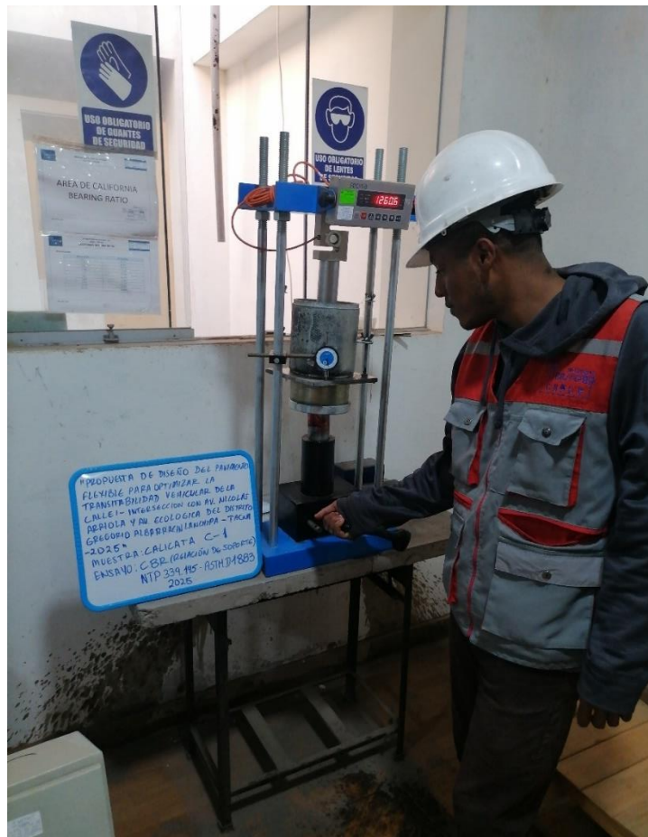
Nota. Realización del CBR de la muestra 1.
