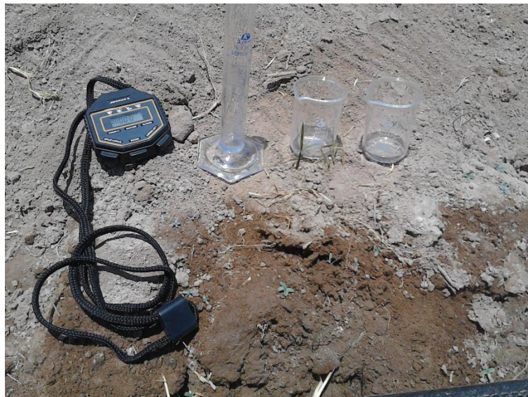
Foto 4. Materiales para la evaluación de caudal de los emisores
