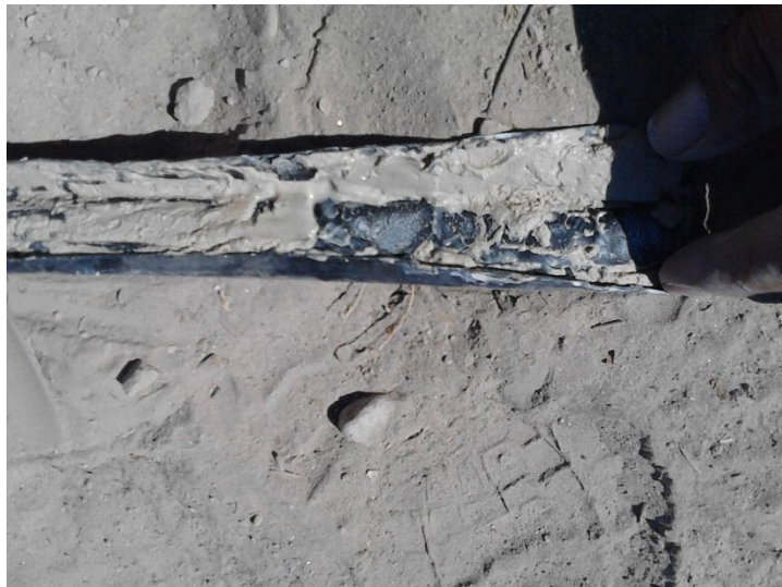
Foto 12. Presencia de sedimentos en interior de la cinta de riego.
