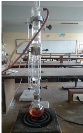
Foto del análisis contenido de grasas, método Soxhlet.
