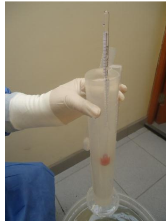
Foto midiendo los grados Baume, con el uso de un densímetro y probeta de 250 ml.
