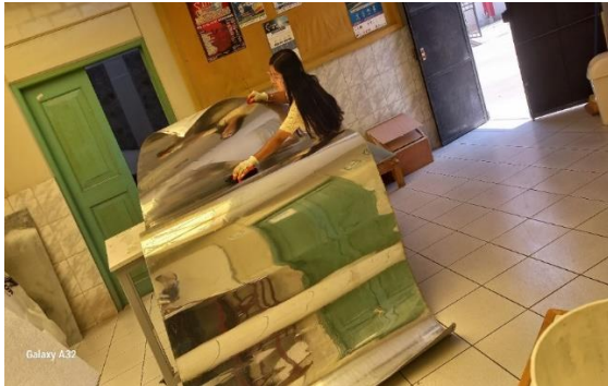
Cortado de las planchas de aluminio anodizado
