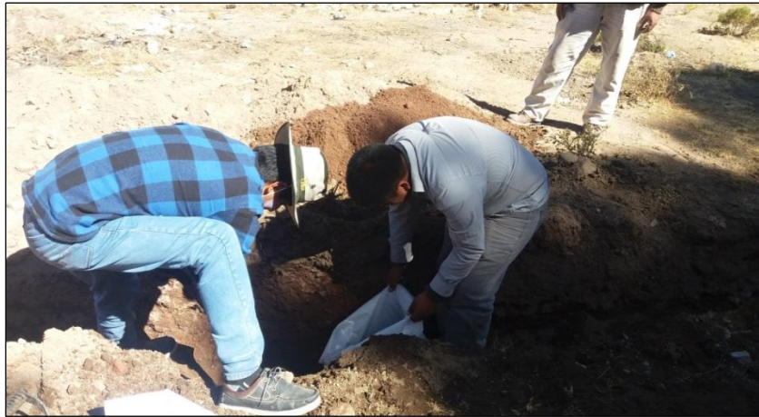
Foto 4.3 Apertura de Calicatas.
