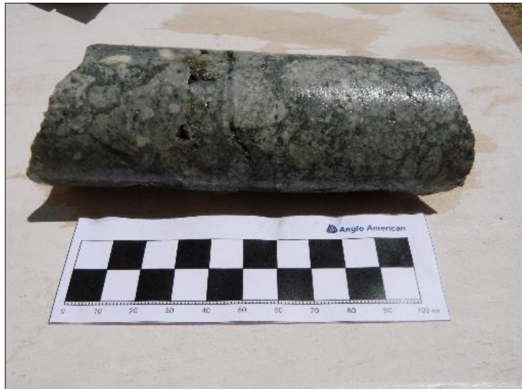
Foto 8. Muestra de mano brecha hidrotermal con fragmentos de Grd y Porf. Tardío, englobados dentro de una matriz fina Fuente: Autoría propia
