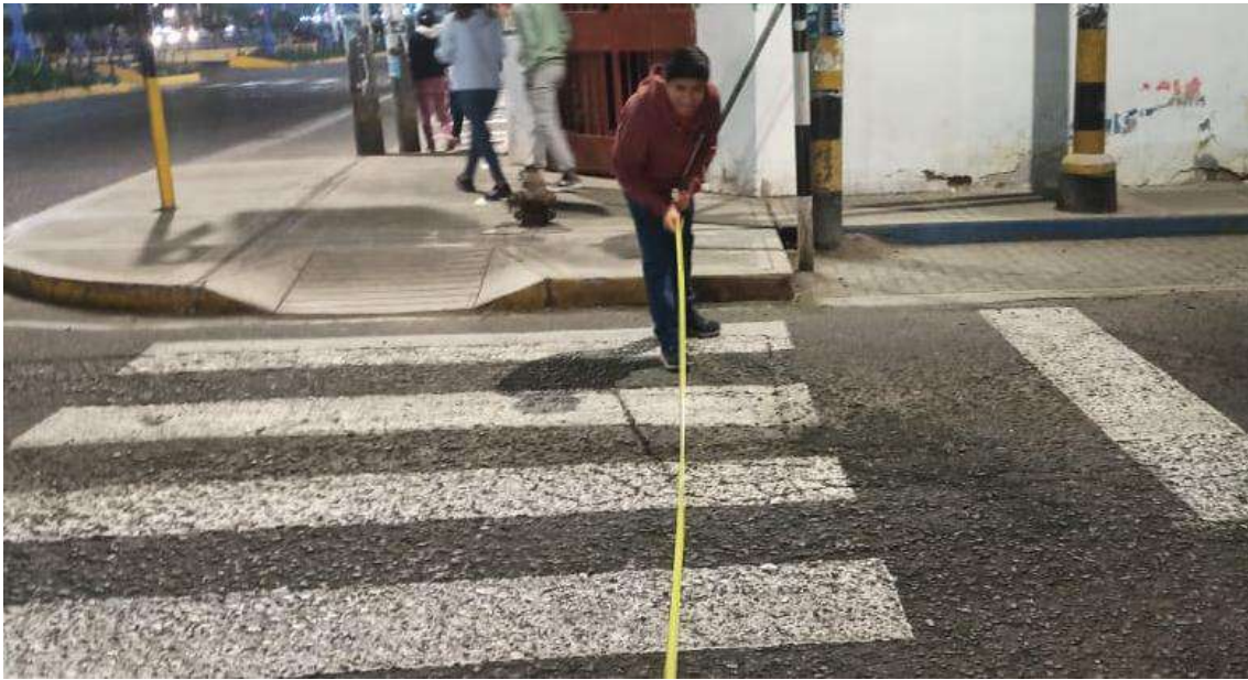
Medición del ancho de carriles en la calle Las Casuarinas (intersección 01)
