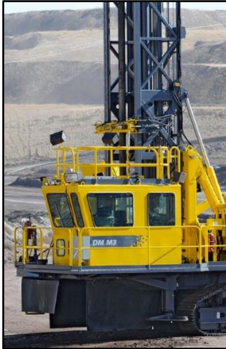
Figura 13. Perforadora con cortina de goma.
