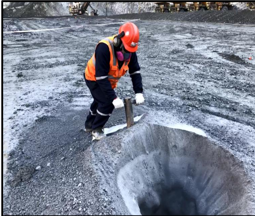
Figura 20. Extracción de muestras de detritos, en cono de perforación, en una posición de 45^\circ con respecto a la base.
