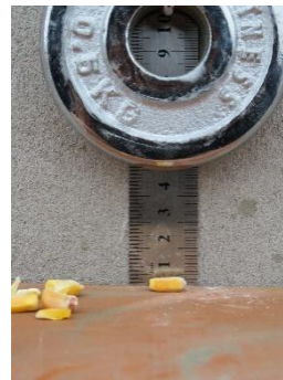
Figura 57. Proceso de fractura del grano Fuente: Elaboración propia
