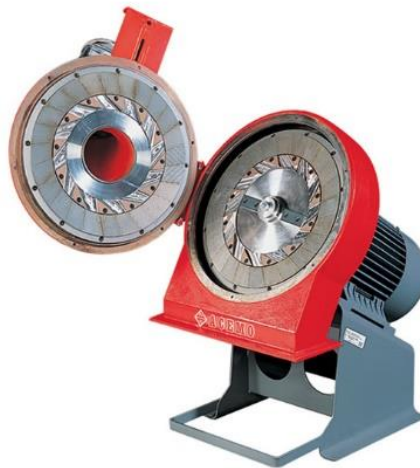
Figura 1. Molino de discos Fuente: www.acemo.com
