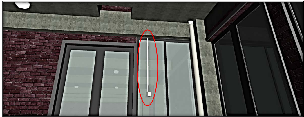
Imagen 17: Interferencia entre switch y pared en comedor del primer nivel
