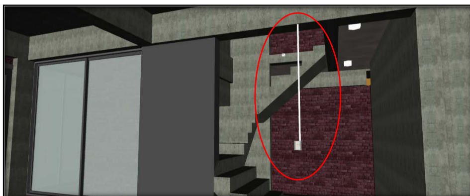
Imagen 19: Incompatibilidad pared – switch en todos los niveles del hotel 3 estrellas
