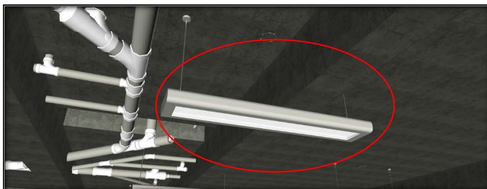
Imagen 18: Incompatibilidad viga – luminaria en sótano del hotel 3 estrellas
