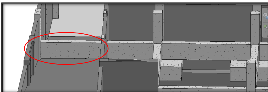
Imagen 15: Interferencia cimentación – rampa en sótano del hotel 3 estrellas
