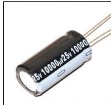
Figura 65. Izquierda, Batería 6LR61 y AA. Derecha, Condensador electrolítico de 25V y 10mF.
