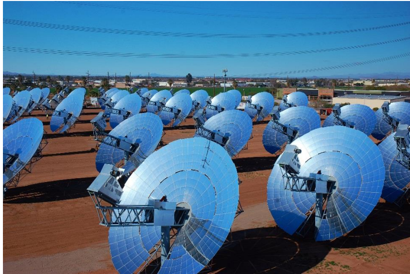
Figura 23. Campo termosolar de seguidores con motor Stirling. (Recuperado de: http://www.gmdsol.com/blog/energia-termsolar-iv-motor-stirling/ , 2016)
