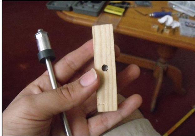
Figura 82. Acople de madera para el eje de declinación y varilla pequeña de acero.
