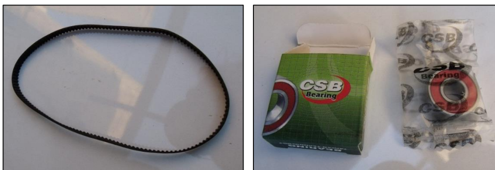
Figura 45. Izquierda, Correa de transmisión dentada. Derecha, Rodamientos 608 – 2NSL
