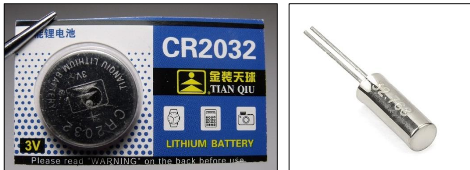
Figura 59. Izquierda, Batería de Lithium de 3V modelo CR2032. Derecha, Cristal de 32,768 Hz
