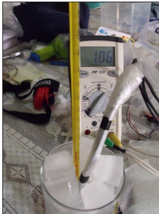
Figura 97. Proceso de calibración de los sensores de temperatura.
