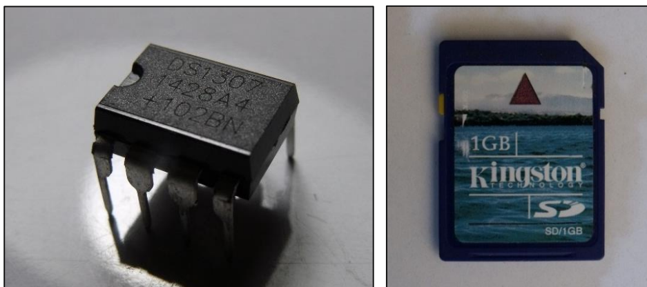
Figura 58. Izquierda, RTC DS1307. Derecha Tarjeta SD marca Kingstone de 1GB.
