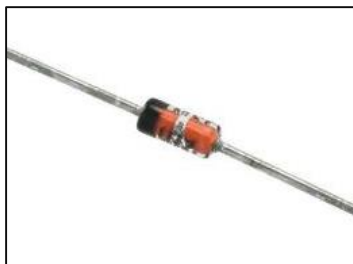
Figura 63. Izquierda, Diodo zenner de 6V. Derecha, Rectificador MCR 106.
