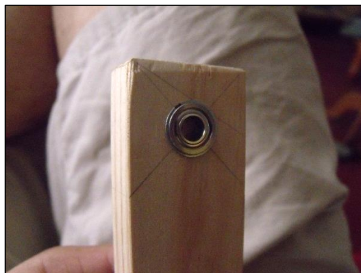
Figura 80. Colocación de rodamientos para los ejes de los motores.
