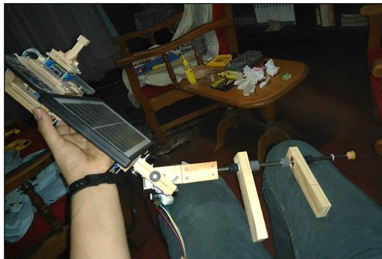
Figura 83. Proceso temprano de armado del seguidor solar
