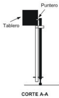
Figura N° 3 Esquema del Rugosímetro MERLIN
