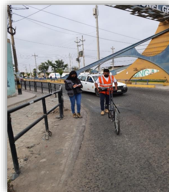
Figura 7 Uso del Rugosímetro Merlín
