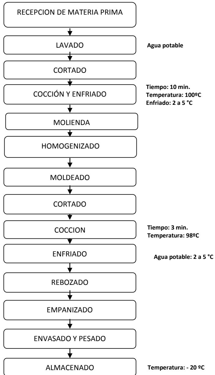
Figura 41. Diagrama de flujo de elaboración de croquetas a base de retazos de pota ( Dosidicus gigas ).
