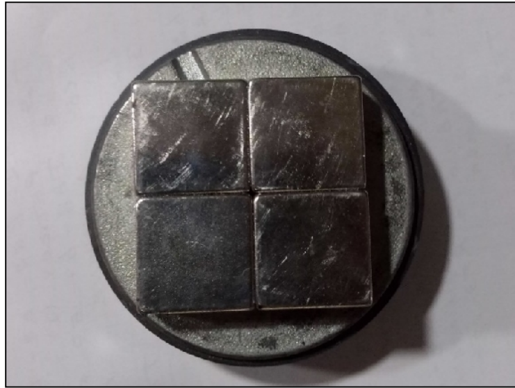
Figura 21: Cubos (30 mm x 30 mm x 15 mm) de imán de neodimio utilizado en ensayo.
