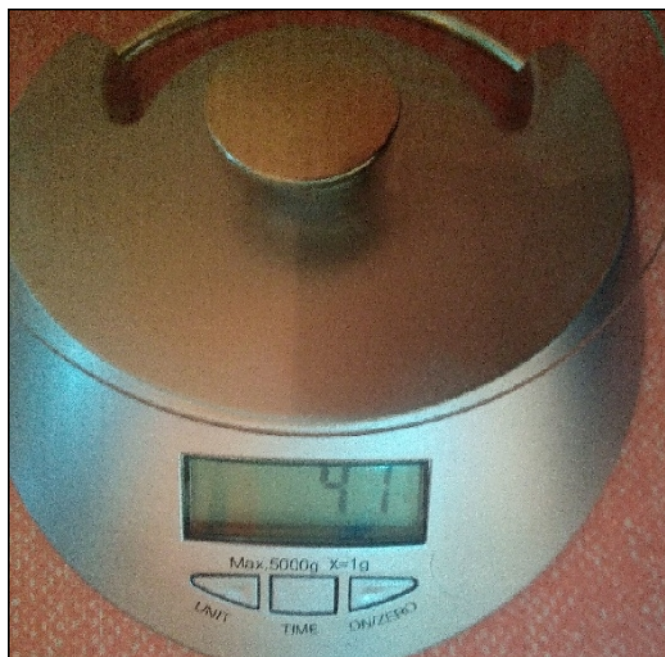
Figura 27: Peso de imán de neodimio de 25 mm de diámetro.
