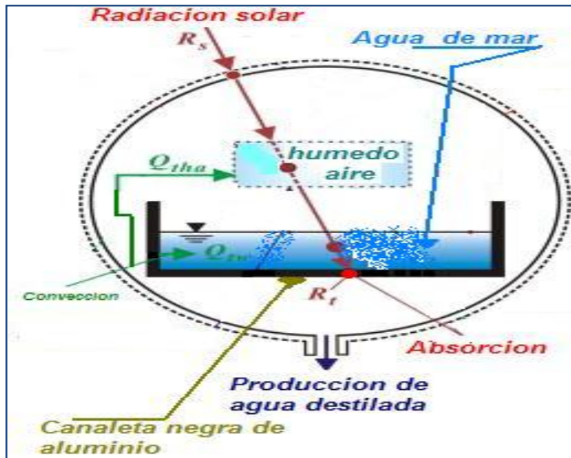
Figura 2.22. Las transferencias de calor de la canaleta negra de aluminio.
