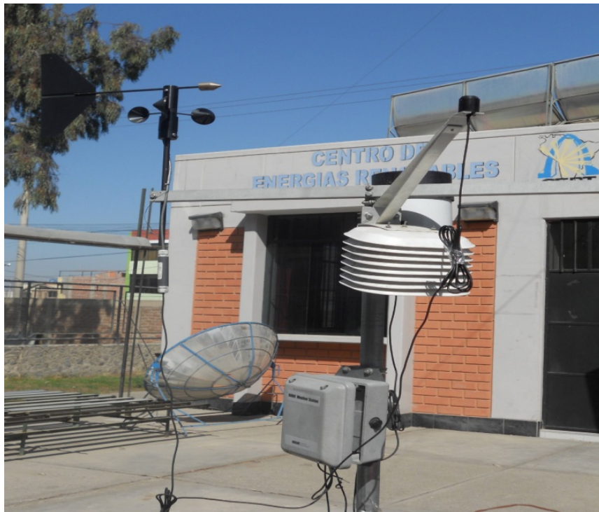
Figura 3.8. Medida de la irradiancia solar global por la estación HOBO.
