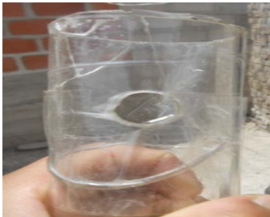
Figura 5.4. Vista frontal del tubo con su respectivo orificio donde sale el agua condensada o agua ya destilada al colector (vaso). Fuente: Elaboración propia. (2012)
