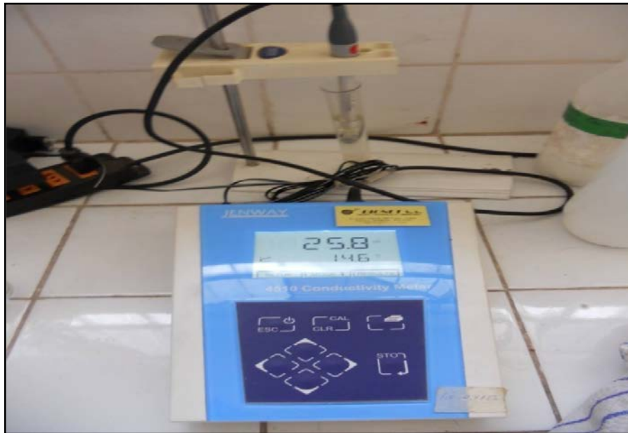
Figura 4.26. Instrumento para la medición de la conductividad eléctrica del agua destilada para el DST. Fuente: Elaboración propia (2012).
