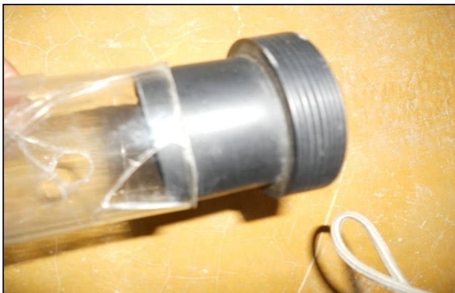
Figura 5.2. El tapón de jebe encajando con el tubo transparente del DST
