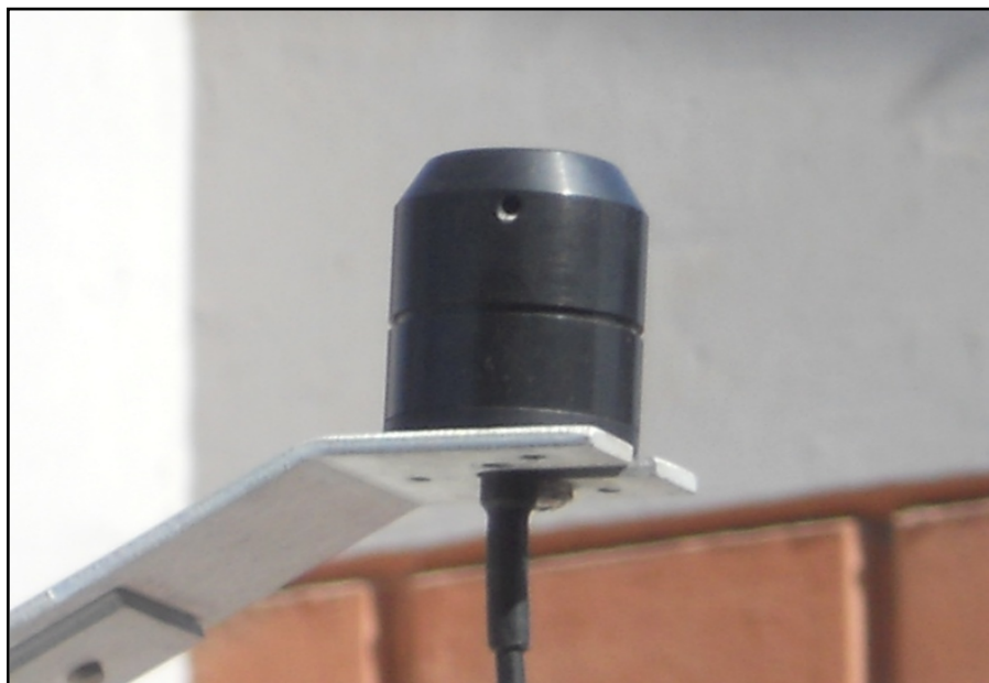
Figura 5.6: Sensor de medida de la radiación solar por la estación HOBO.
