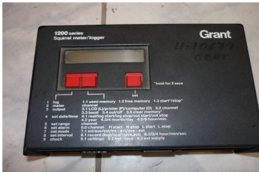
Figura 3.11. Data logger (squirrel) donde se almacena los datos de temperaturas
