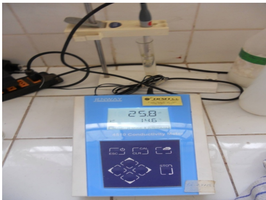
Figura 3.14. Medida de la conductividad eléctrica del agua de mar que se evaluó en el DST.
