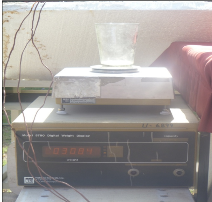
Figura 3.9. Balanza eléctrica que se utilizó para medir la masa de agua destilada
