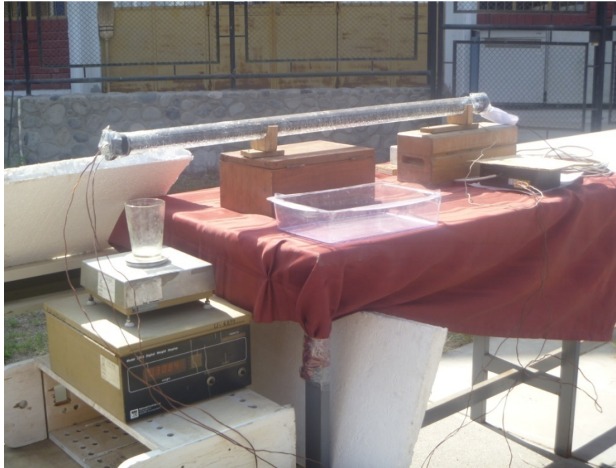
Figura 5.7: Midiendo el volumen de agua destilada con la balanza de laboratorio de física aplicada
