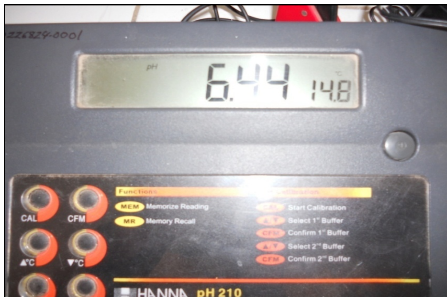
Figura 4.25. Aparato para medir el pH del agua destilada en el Laboratorio de química analítica de la UNJBG del DST. Fuente: Elaboración propia (2012).
