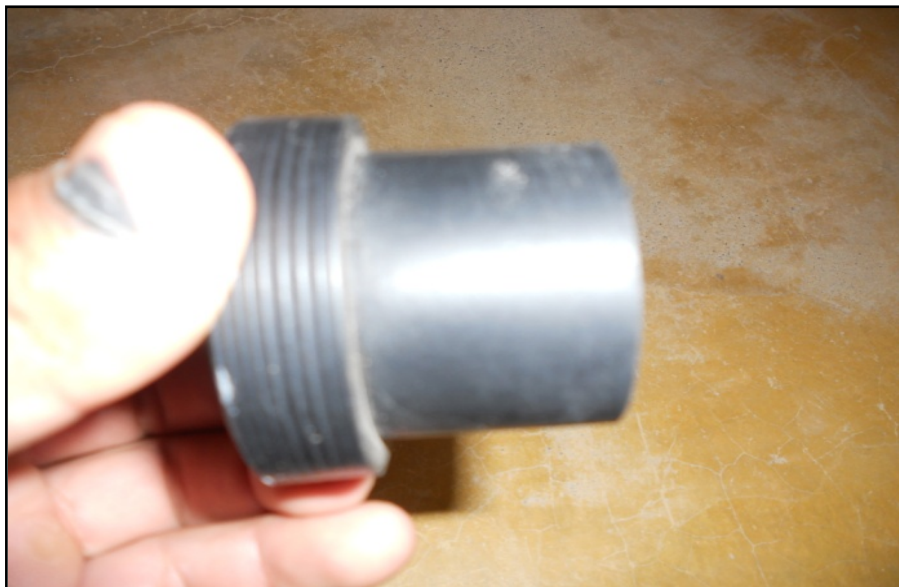
Figura 5.1. El tapón de jebe que lo utilizamos para el tubo del DST Fuente: Elaboración propia. (2012)
