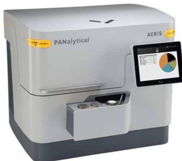
Figura 5. - Difractómetro de banco AERIS de la UNJBG
