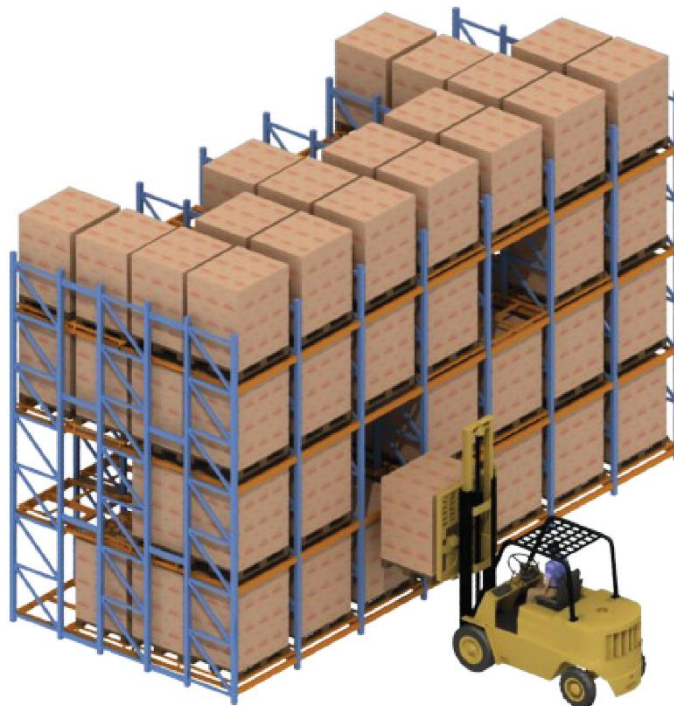
Figura 39: Estantería Push back Fuente: Tesis de grado en ingeniería industrial, planificación básica de un centro de distribución.2011
