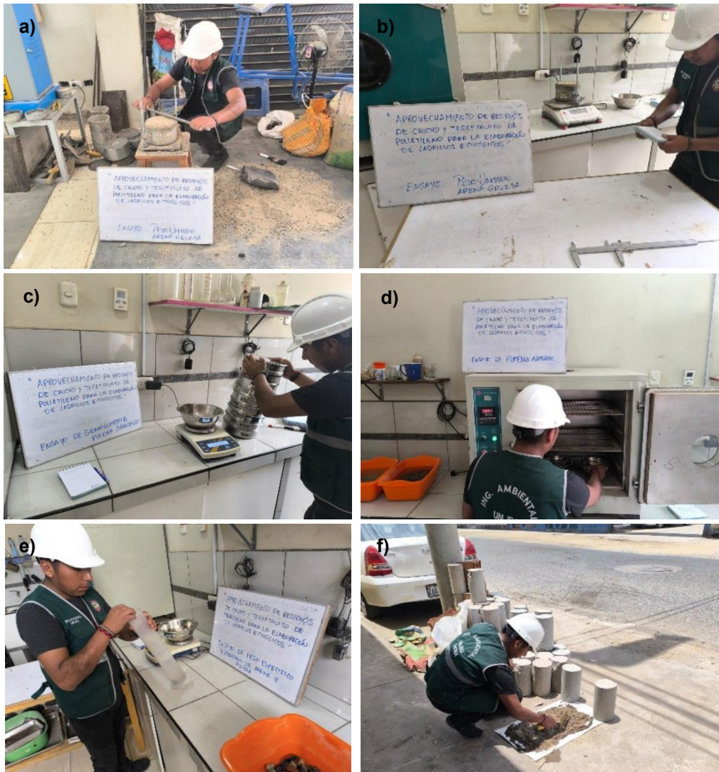
Fotografía 1. Proceso para determinación de diseño de mezcla
