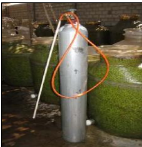
Figura 13. Tanque de Dioxido de carbono con la columna de aplicación
