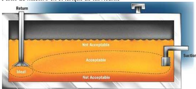
Figura 38 Punto de muestro en el tanque de lubricante
